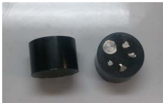
Figura 15. Mostres embutides en baquelita
