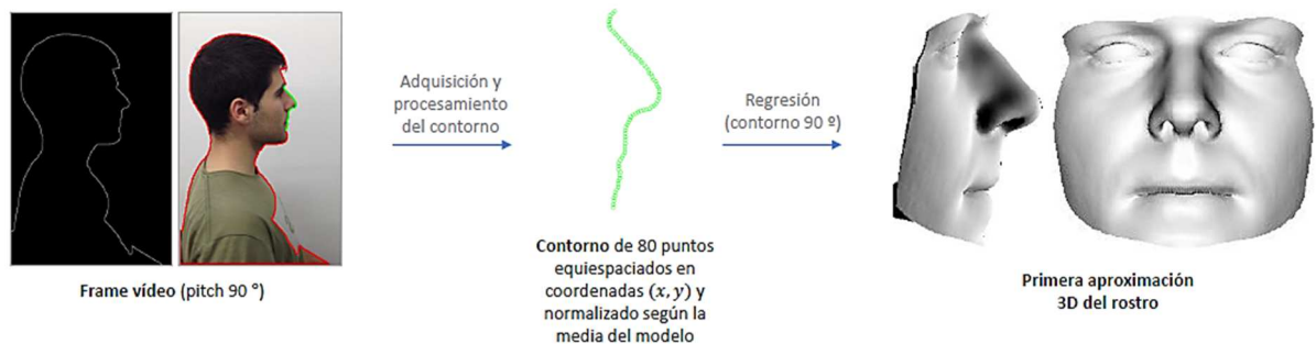
Figura 23. Ejemplo - Primera aproximación 3D del rostro. Previamente, selección del frame pitch 90^\circ y procesado del contorno para que pueda ser introducido en el Regresor (contorno de 80 puntos (x,y) equiespaciados y normalizados según la media del modelo a 90^\circ ).
