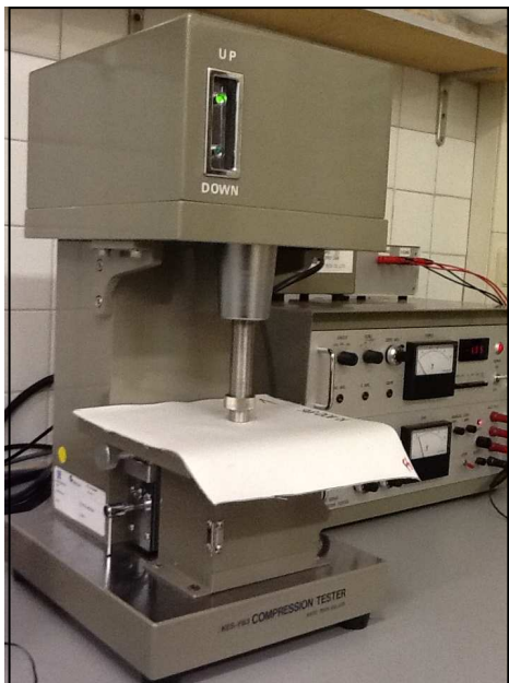
Figura 202. Izquierda: Unidad de medida del grosor en el equipo KES-FB del Laboratorio de parametría física textil. Instituto de Investigación Textil y Cooperación Industrial de Terrassa. Universitat Politècnica de Catalunya. Derecha: Expresión gráfica de los resultados del ensayo de compresión (53)
