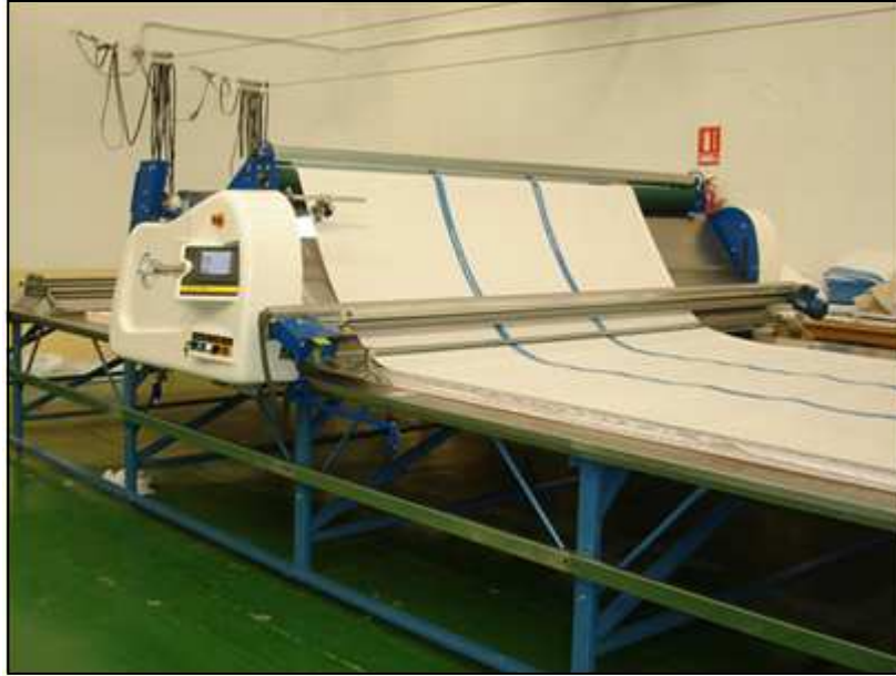
Figura 179. Operación de extendido. Fuente: trazoycorteind
