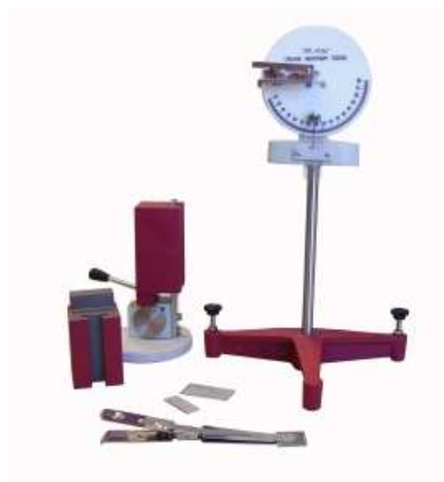
Figura 131. Equipo de medida de la capacidad de desarrugado de un tejido. Fuente: SDL-Atlas
