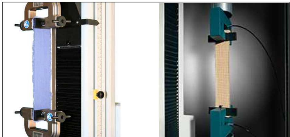
Figura 15. Ensayo método de tiras. Fuentes: Izquierda Instron . Derecha: Vidal-protection
