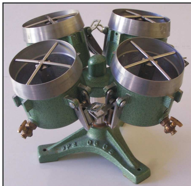
Figura 82. Dispositivo de sujeción de las probetas, cubetas y grifo para la descarga del agua que ha atravesado la probeta. Fuente: kod.tul.cz
