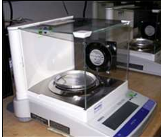
Figura 96. Instrumentación para el ensayo del tiempo de secado. Fuente: NCSU
