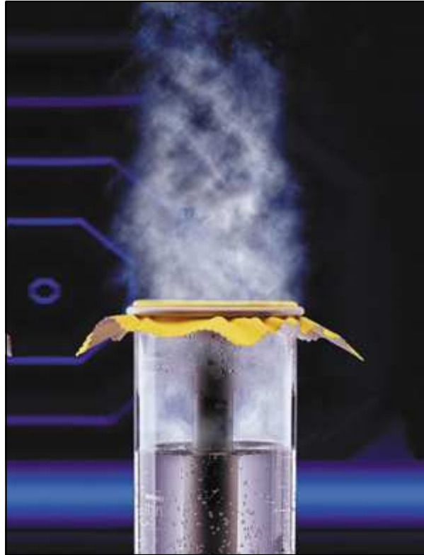
Figura 90. La permeabilidad al vapor de agua de un tejido es una propiedad básica para evaluar su confort. Fuente: goreprotectivefabrics
