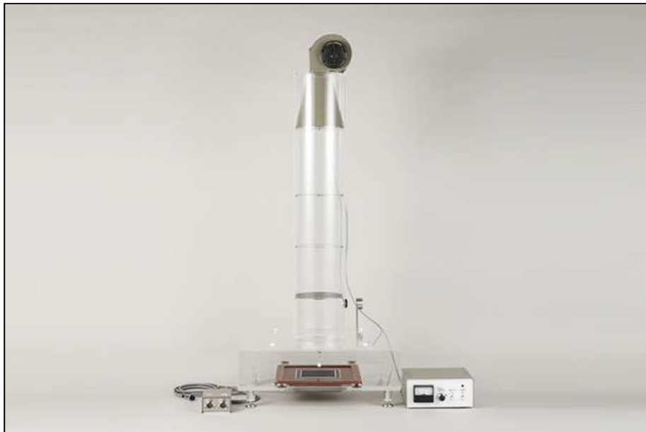
Figura 152. Columna de viento del Thermo Labo. Fuente: keskato
