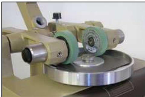
Figura 117. Detalle del cabezal de los elementos abrasivos. Fuente. TABER
