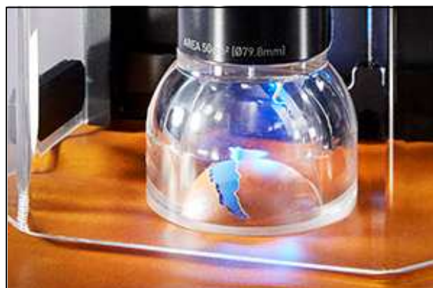
Figura 44. Eclatómetro digital. Fuente: James Heal TruBurst
