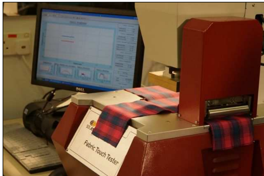
Figura 225. Fabric Touch Tester (FTT). Fuente: HKRITA
