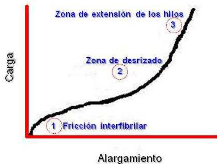
Figura 19. Zonas de la curva carga-alargamiento de una probeta de tejido
