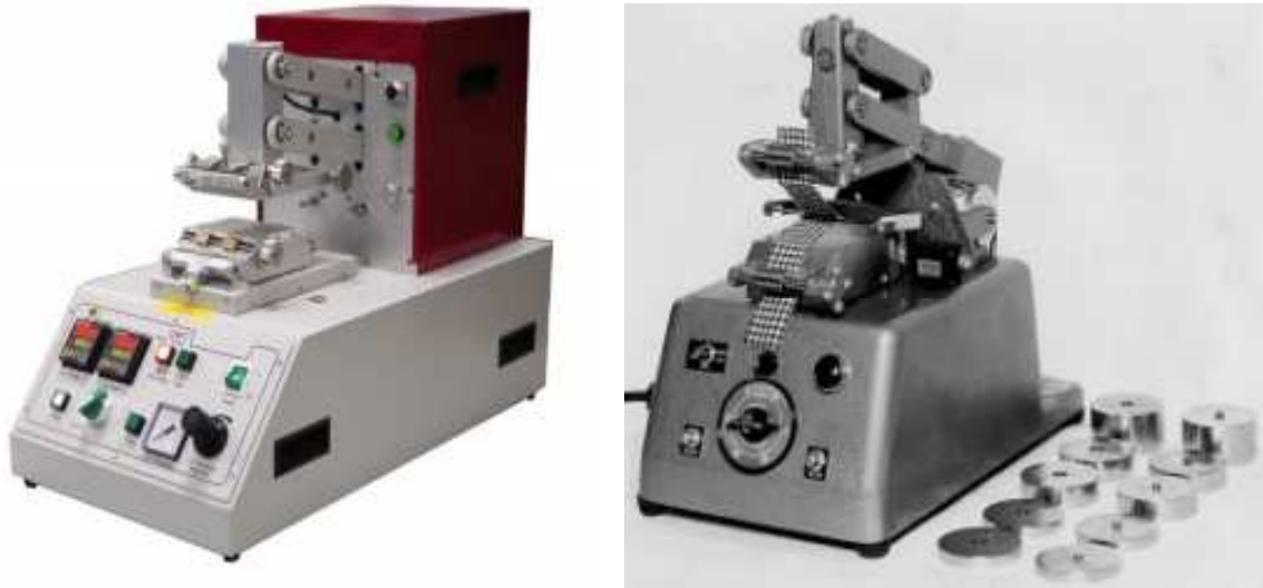
Figura 115. Abrasímetro de flexión. Fuente: Izquierda: SDL-ATLAS
