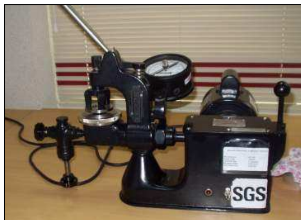
Figura 43. Eclatómetro analógico hidráulico de glicerina. Fuente GarmensTech
