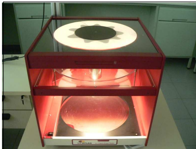
Figura 56. Vista superior de la versión actual del drapómetro Cusick comercializado por SDL Atlas. Fuente: (44)
