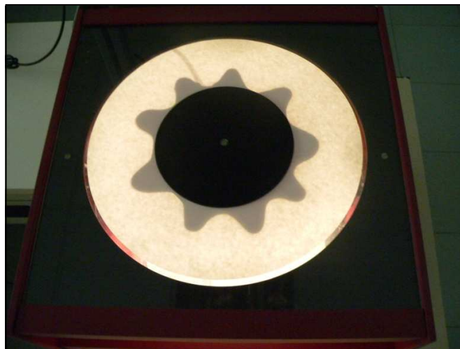
Figura 58. Perfil de la sombra proyectada del cayente del tejido en la drapómetro Cusick. (44)
