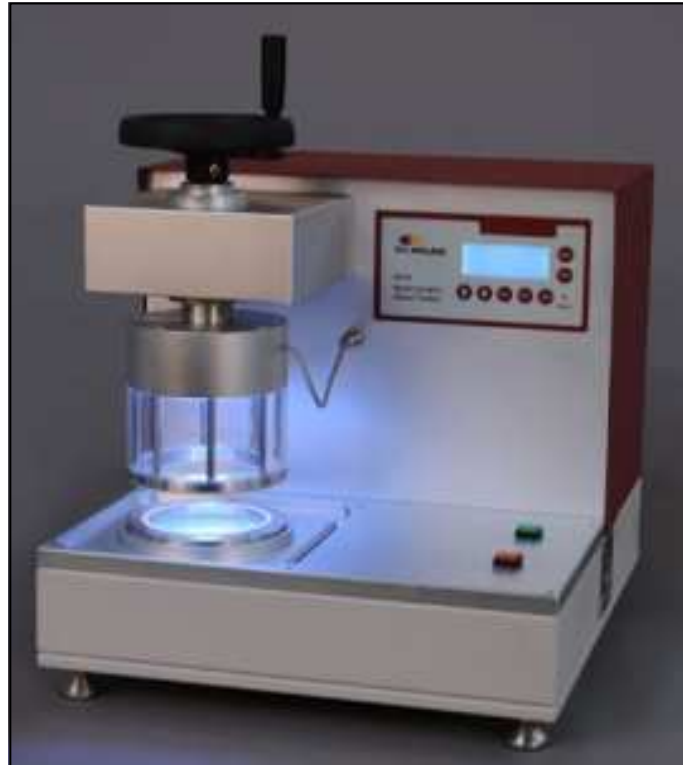
Figura 76. Equipo de medida Hydrostatic Head Tester M018. Fuente: SDL Atlas
