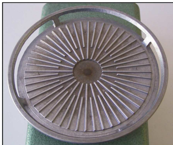
Figura 84. Disco de la centrífuga. Fuente: kod.tul.cz
