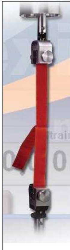
Figura 32. Ensayo de apertura de cintas tipo Velcro.
