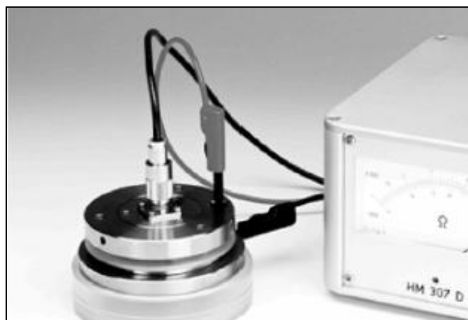
Figura 153. Cabezal de medición de la resistividad eléctrica superficial. (70)
