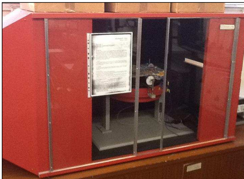
Figura 138. El equipo TOG METER se encuentra ubicado en una cabina de ensayo protegida del ambiente exterior. Laboratorio de física textil. Universidade do Minho, Guimaraes (Portugal).
