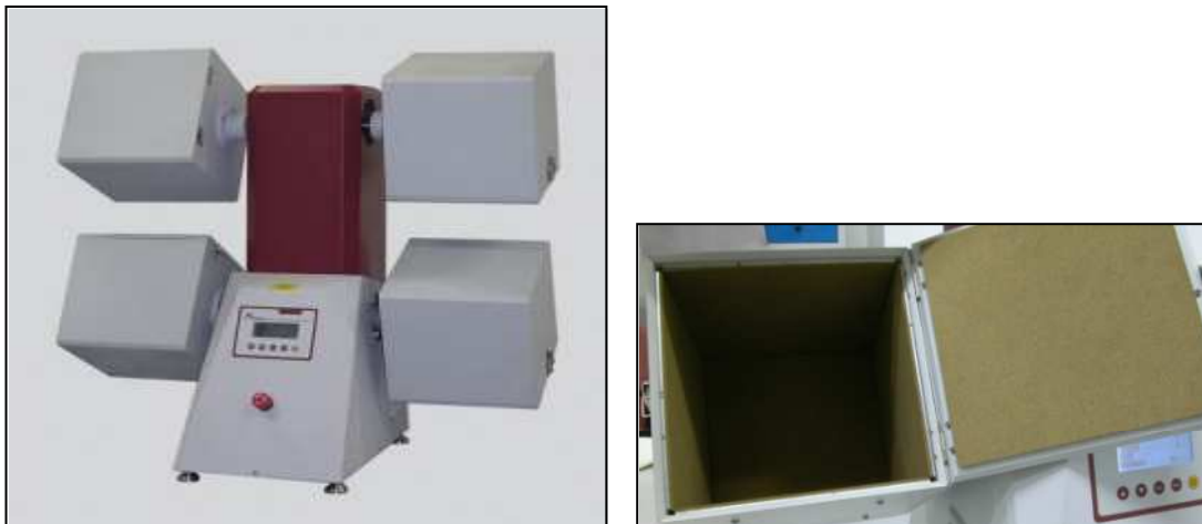
Figura 104. ICI/M&S Pilling and Snagging Tester. Fuente: SDL-ATLAS
