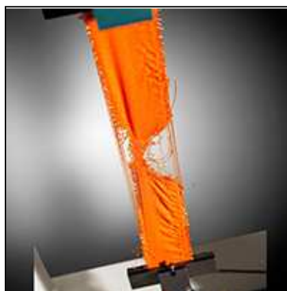
Figura 17. Ensayo resistencia a la tracción. Fuente : Vidal-Protection
