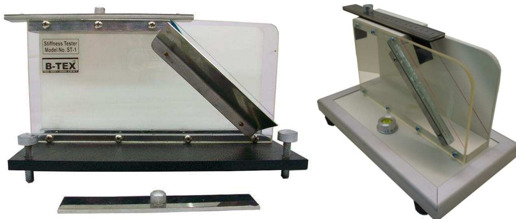
Figura 52. Imágenes del medidor de rigidez. Izquierda: B-tex Derecha: Wealth Town
