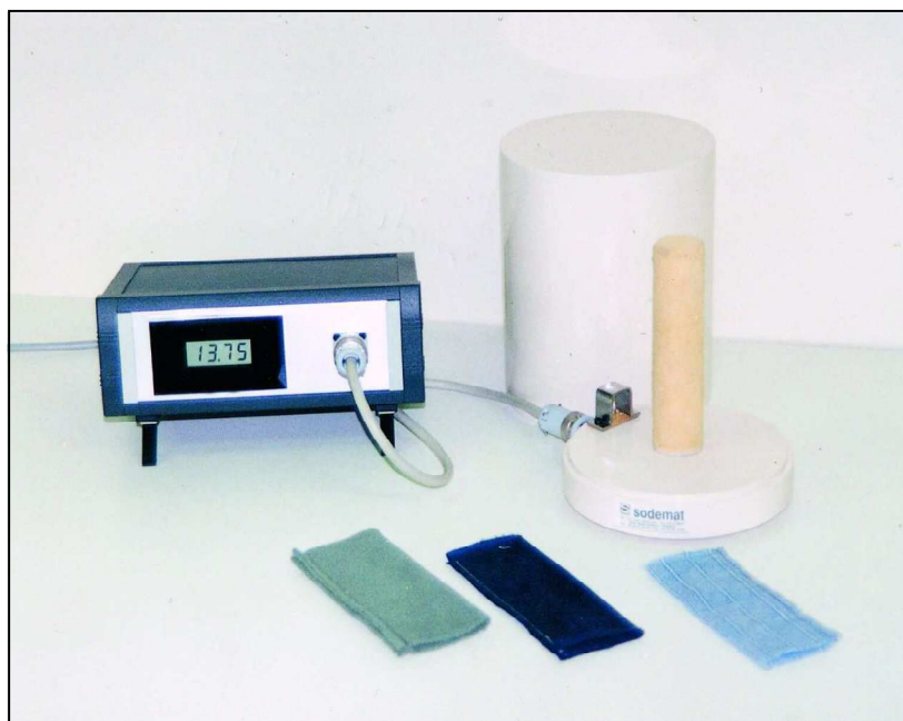
Figura 142. Medidor del poder adiatérmico. Fuente: SODEMAT
