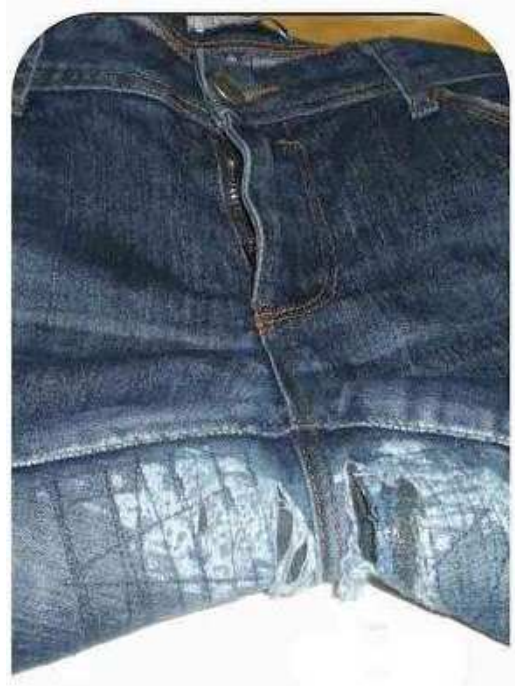
Figura 113. Desgaste por rozamiento en la entrepierna de un pantalón. Fuente: Red facilisimo
