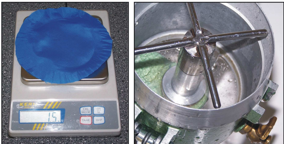
Figura 88. Izquierda, pesado de la probeta centrifugada. Derecha, medición del volumen de agua que ha traspasado el tejido. Fuente: kod.tul.cz
