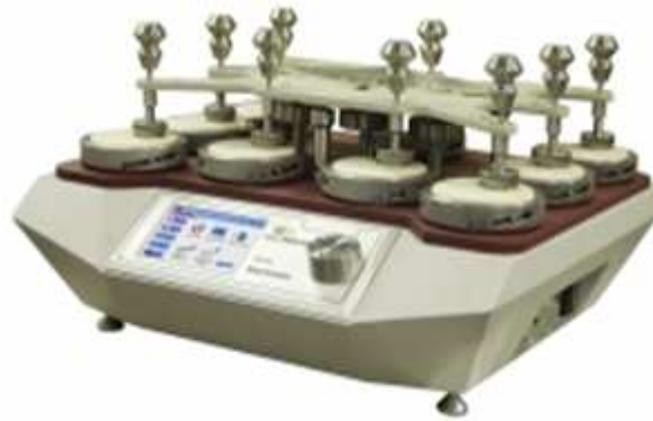
Figura 118. Abrasímetro Martindale. Fuente: Indiamart
