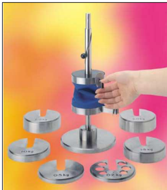
Figura 132. AATCC Wrinkle recovery tester. Fuente: James H. Heal
