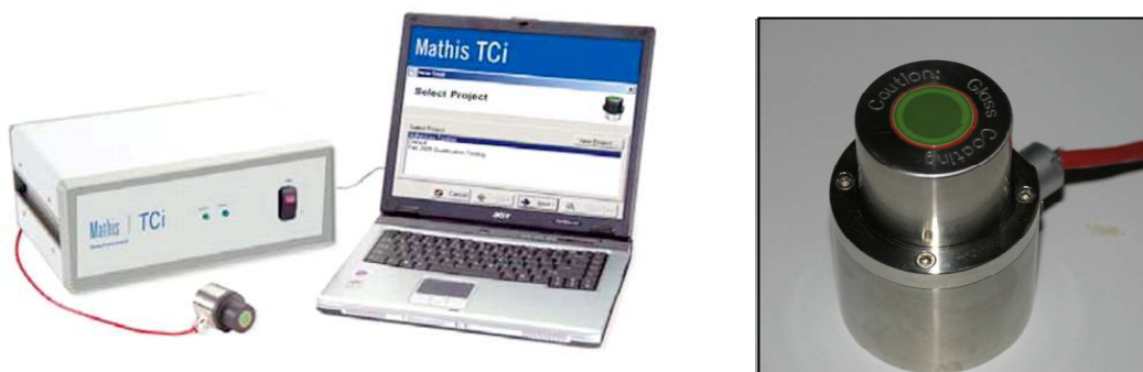
Figura 141. Equipo Mathis TCi y cabezal de medida. Fuente: ndt
