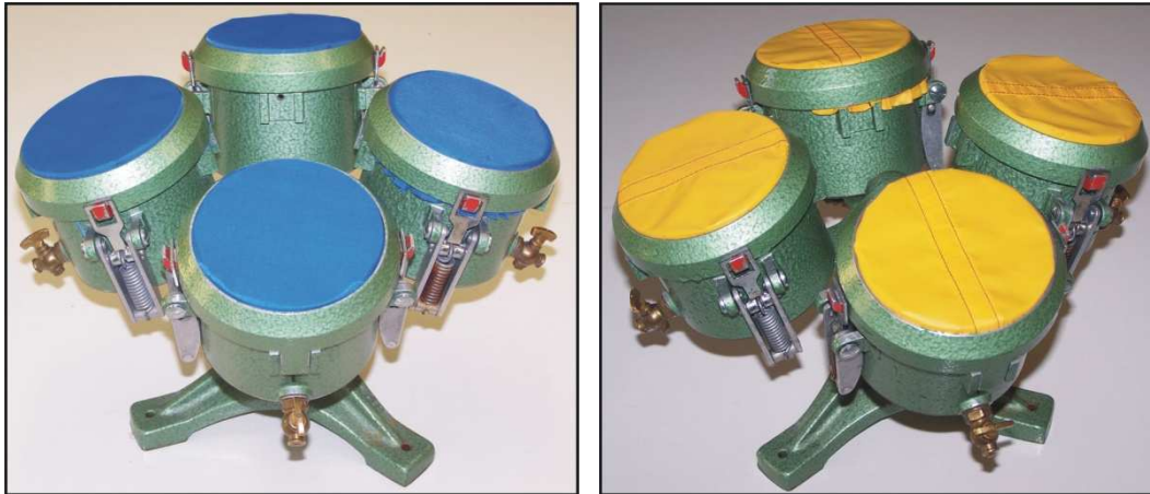
Figura 83. Imagen de las probetas montadas sobre las cubetas y fijadas mediante el anillo de sujeción. Fuente: kod.tul.cz
