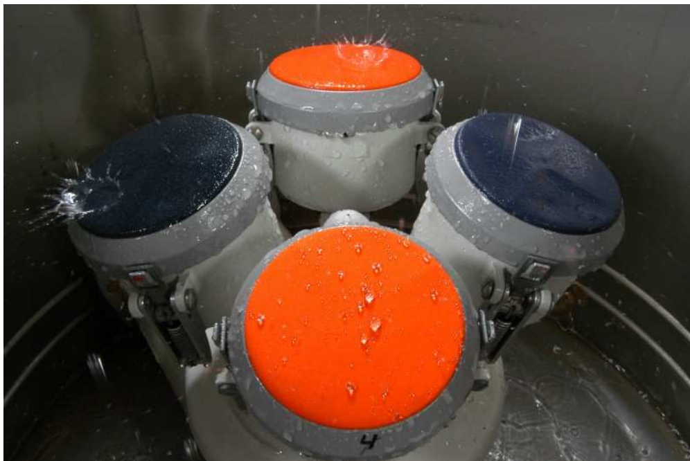
Figura 86. Las probetas durante el ensayo de exposición a la lluvia artificial. Fuente: honestein
