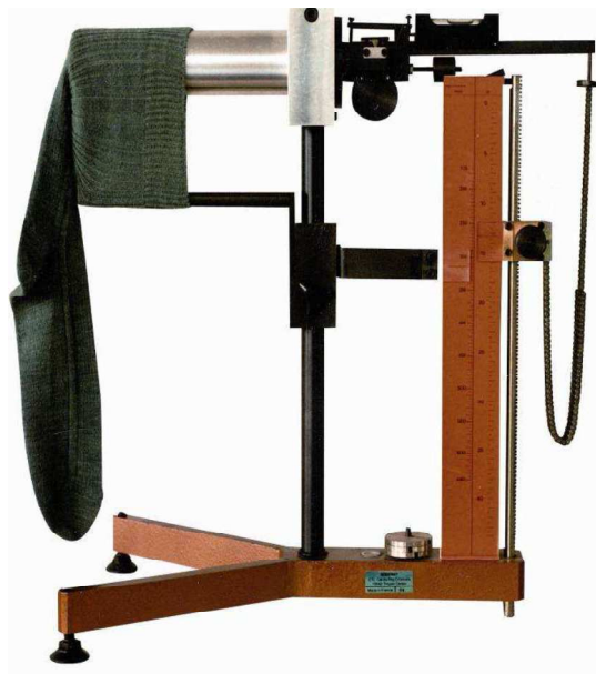
Figura 45. Equipo de medida de la fuerza de compresión de las prendas. Fuente: SODEMAT
