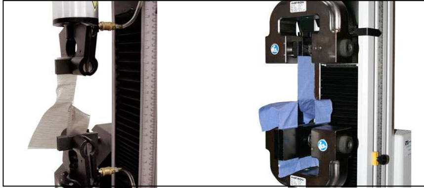
Figura 31. Las dos variantes del ensayo. Fuente: Instron
