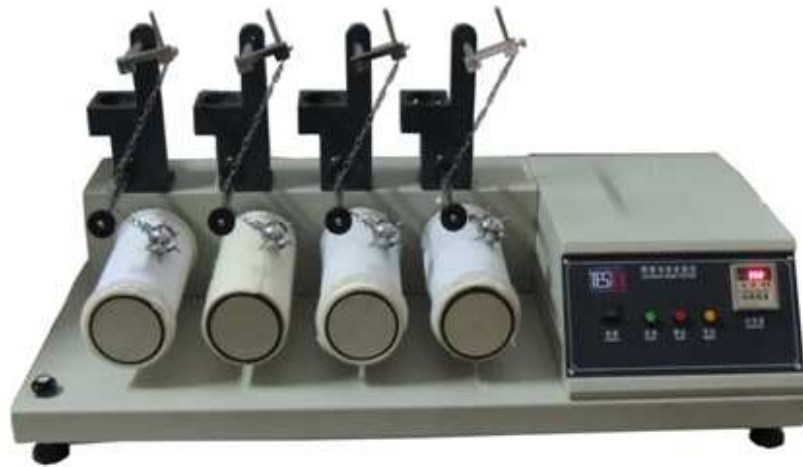
Figura 123. ICI Mace Snag Tester. Fuente: textileinstruments
