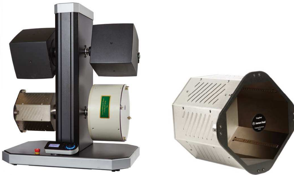
Figura 126. Orbitor 2 Pilling & Snagging tester. Fuente: James Heal
