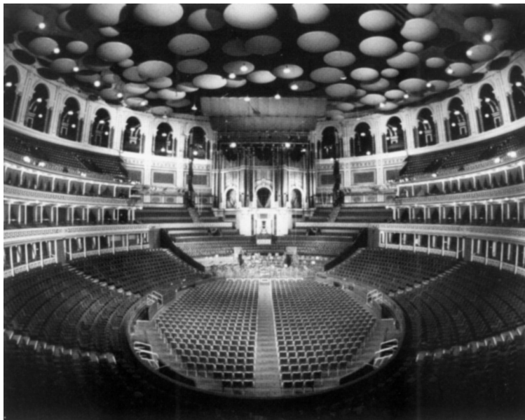
Fig. 5.47 Difusores convexos o “platillos volantes” en el Royal Albert Hall (Londres, Gran Bretaña)
