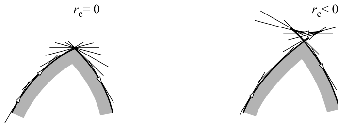
Fig. 4.20 Posibles problemas del perfil de una leva con palpador plano
