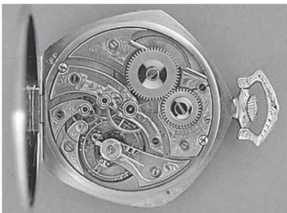
Fig. 3.17 Rellotge de butxaca que ensenya la maquinària
