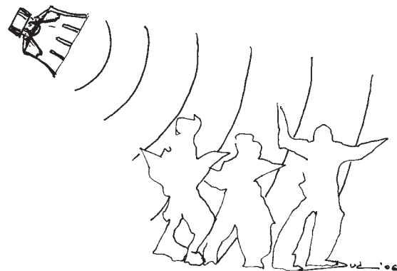
Fig. 2.4 Altaveus focalitzants a la discoteca (esquema de l'autor)
