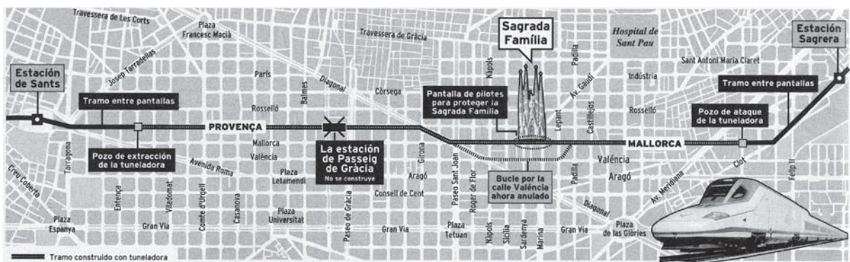
Fig. 4.33 Desviació del recorregut del TGV per evitar problemes amb la Sagrada Família, Barcelona (font: La Vanguardia)
