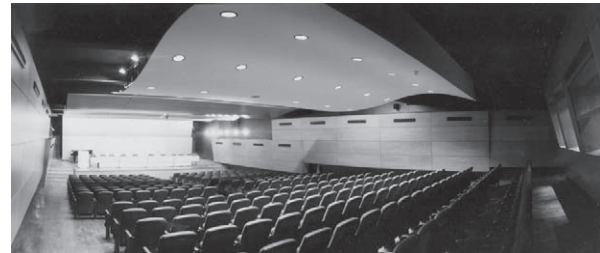
Fig. 7.32 Pla reflector òptim al final de la sala de l'ETSEIB (fotografia UPC)
