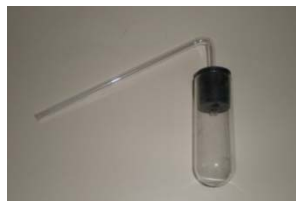
Figura 6.3. Muntatge per a la recollida del gas produït en una reacció
