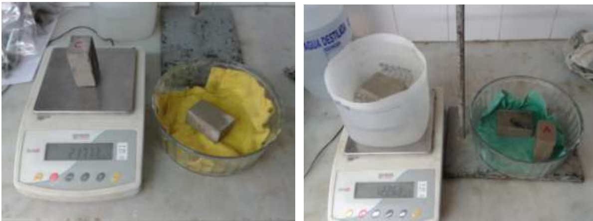
Figura 26. (a) Pesada de la massa saturada (b) Pesada de la massa hidrostàtica
