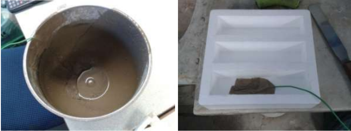
Figura 12. Termoparells (a) Dins recipient de pastadora (b) Dins del motllo.
