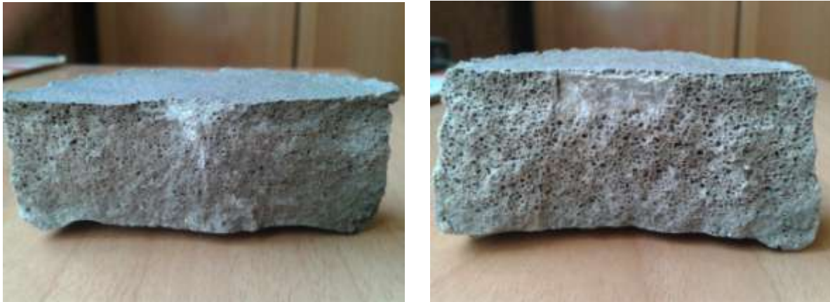
Figura 28. Provetes amb relació A/S=0,27 (a) 2% d'additiu (b) 5% d'additiu
