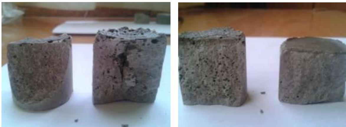
Figura 27. (a) Provetes amb 0,29 A/S i 0-2% d'additiu (b) Provetes amb 0,27 A/S i 0-2% d'additiu
