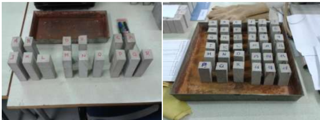
Figura 23.(a) Parts sobrants de la placa. (b) Provetes de mida 75 x 40 x 35 mm
