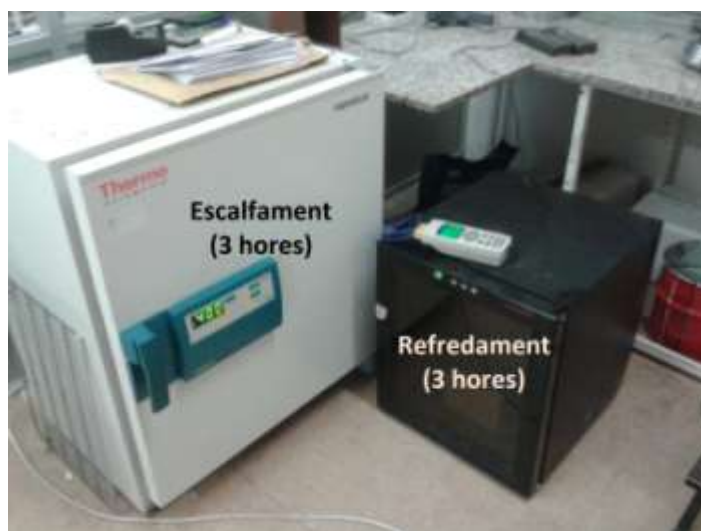
Figura 22. Assaig de cicle escalfament-refredament
