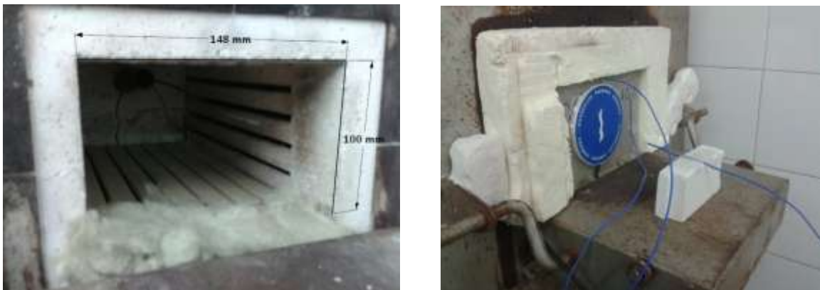
Figura 19. (a) Entrada de la mufla (b) Muntatge final de l'assaig
