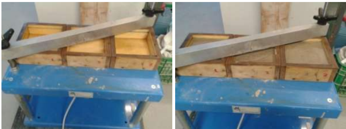
Figura 10. Motllos (a) Col·locats a la taula vibratòria (b) Després del darrer vibrat.
