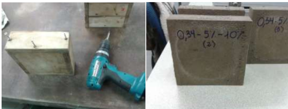
Figura 11. (a) Desemmotllament de provetes (b) Metodologia de retolació.
