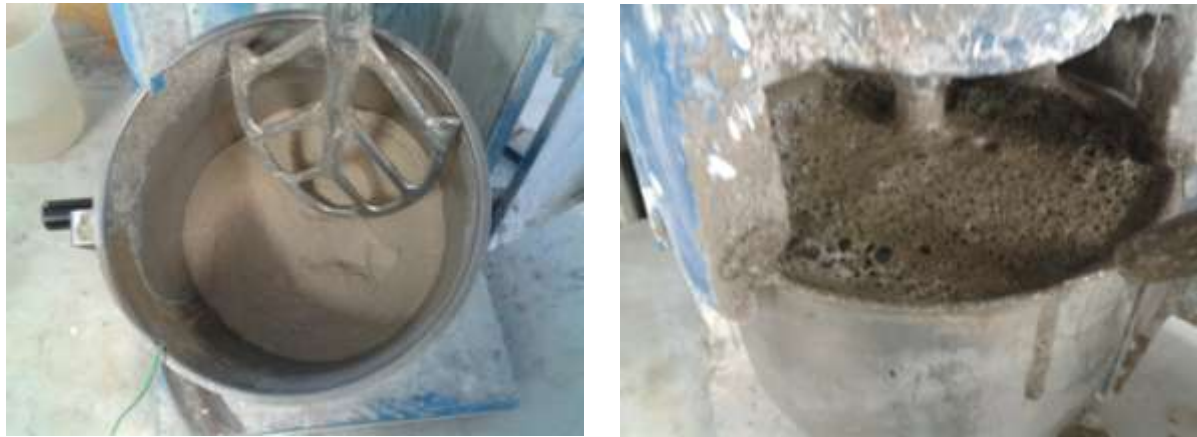
Figura 9. Recipient (a) abans de l'inici de la pastada (b) durant l'aturada als 2 min i 20 s.
