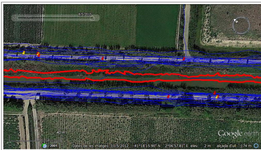
Figura 4.22: Exemple de com les trajectòries de dos camins propers s'influencien unes amb les altres, fent que els camins del mapa generat no siguin els correctes. En vermell hi ha el mapa generat, en blau les trajectòries, les icones vermelles són els girs detectats i les icones grogues les interseccions que aquests girs generen. Imatge extreta de Google Earth en el Delta del Llobregat .
