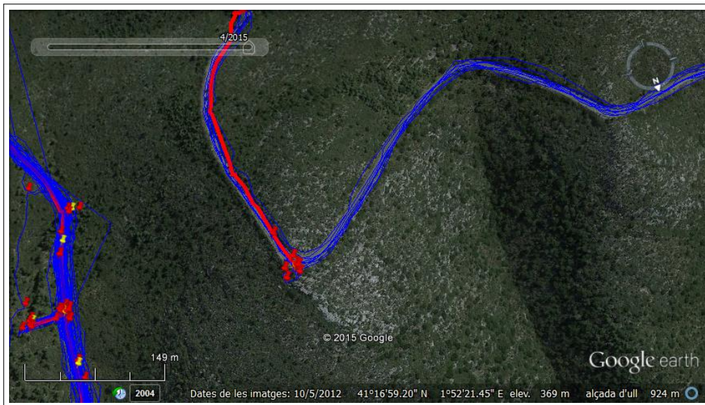
Figura 4.20: Imatge sobre com la no detecció de girs causa la pèrdua de camins en el mapa generat. En vermell hi ha el mapa generat, en blau les trajectòries, les icones vermelles són els girs detectats i les icones grogues les interseccions que aquests girs generen. Imatge extreta de Google Earth en els Aiguamolls Baix Empordà .
