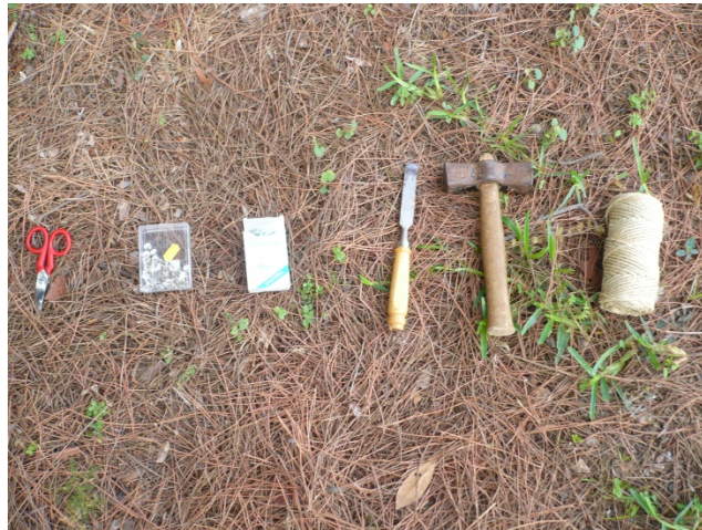
Il·lustració 26. Materials necessaris pel mostreig (estisores, claus, portaobjectes, escarpa, martell i corda)
