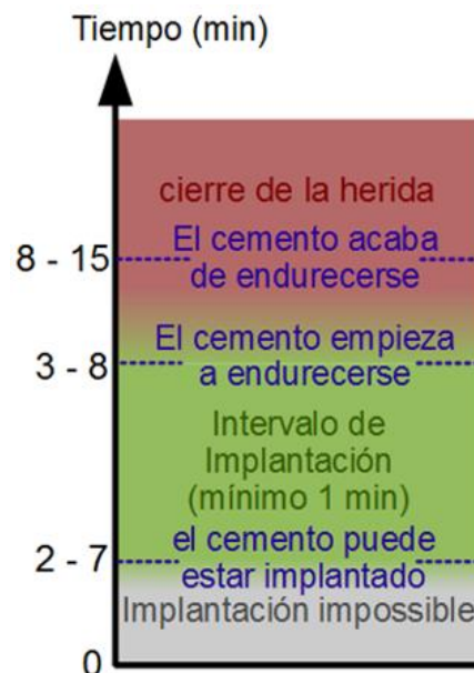
Figura 6: Condiciones para el implantación de un cemento en el organismo. (Adaptado de [1])
