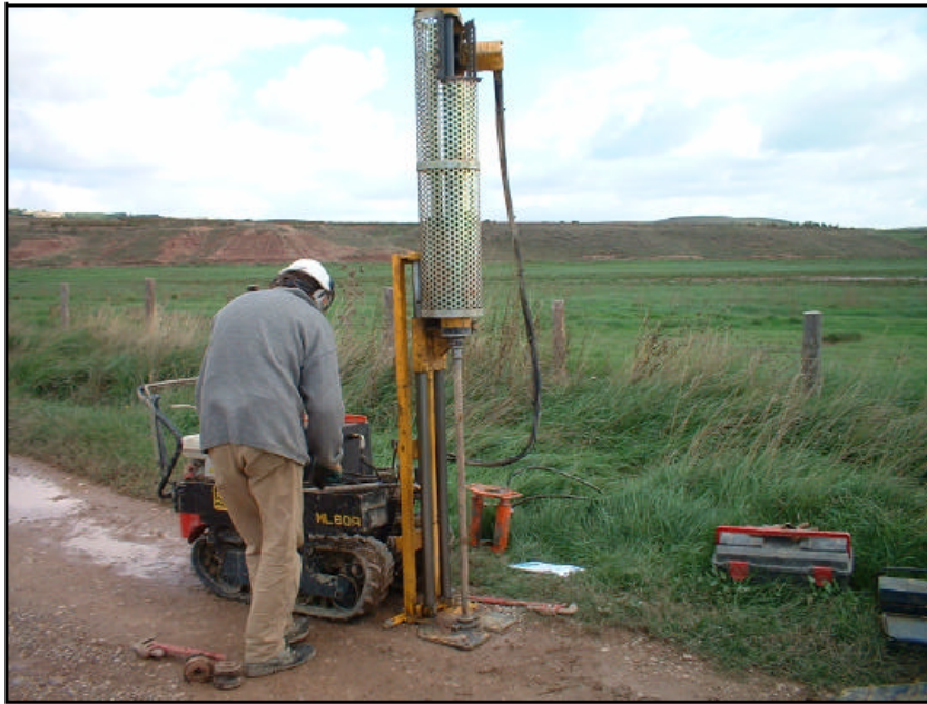
Foto 1: Emplazamiento del ensayo de penetración n° 1.
