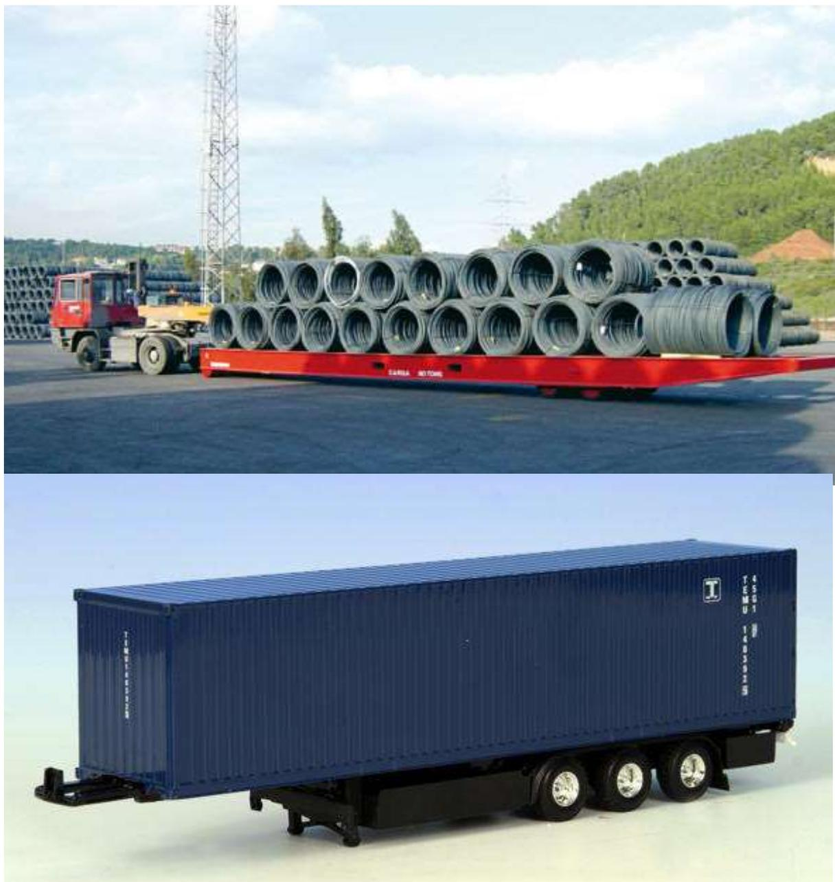
**Ilustración 20. Plataforma rolltrailer enganchada al mafi y remolque.**
