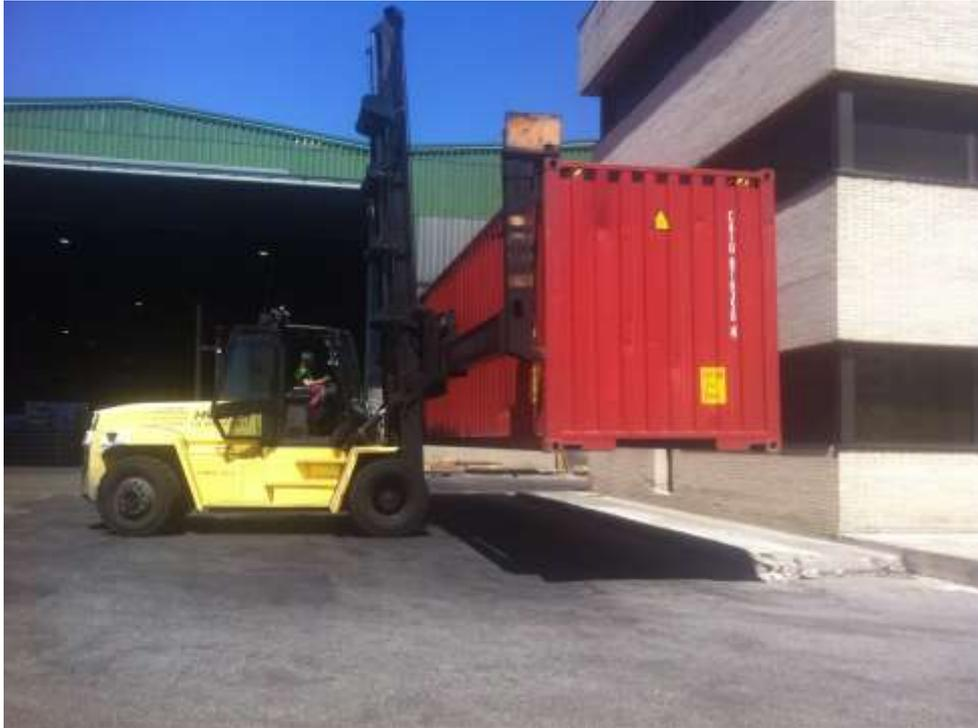
**Ilustración 24. Carretilla elevadora con spreader o “Front loader”. (Fuente:propia)**
