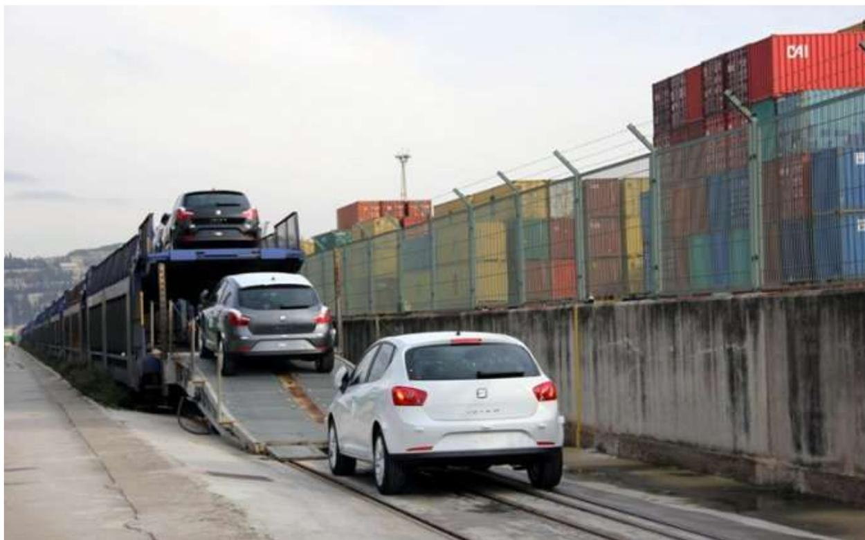
**Ilustración 10. Rampa de carga/descarga de vehículos.-**(Fuente:[www.elvigia.com](http://www.elvigia.com))
