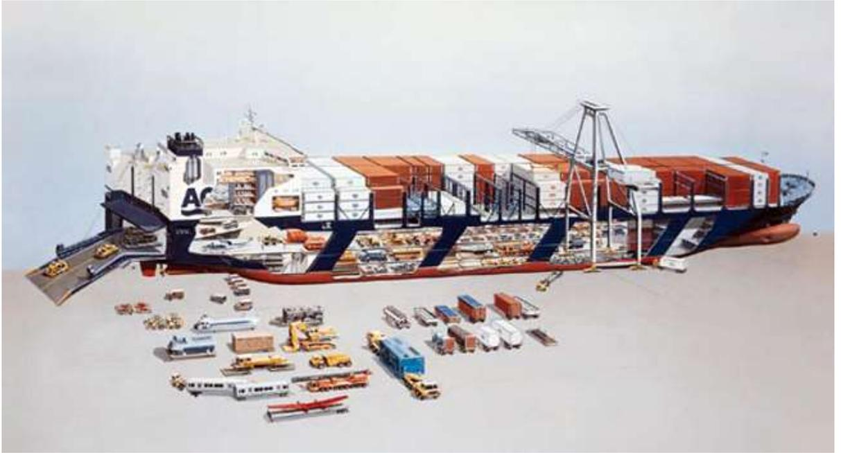
Ilustración 7. Buque mixto Ro-ro/container- (Fuente: [www.linervision.com](http://www.linervision.com))
