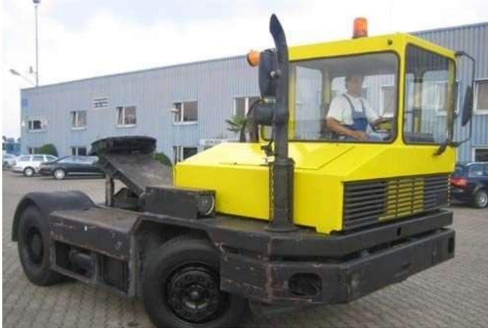
**Ilustración 21. Cabeza tractora o “mafi”.-**(Fuente:[www.trucks.nl](http://www.trucks.nl))
