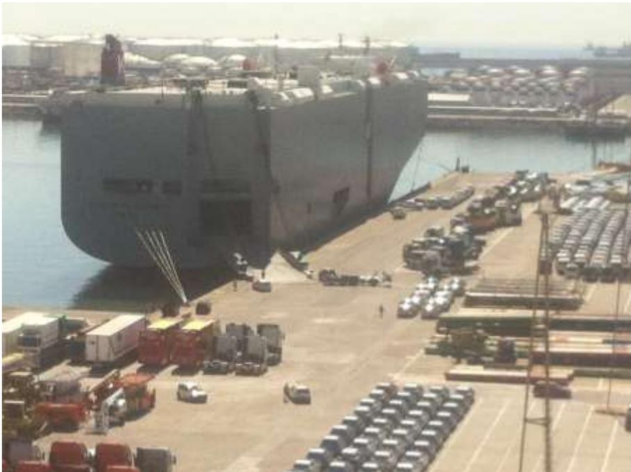
**Ilustración 18. Buque Ro-Ro con rampa apoyada en el tacón.-(Fuente: propia)**
