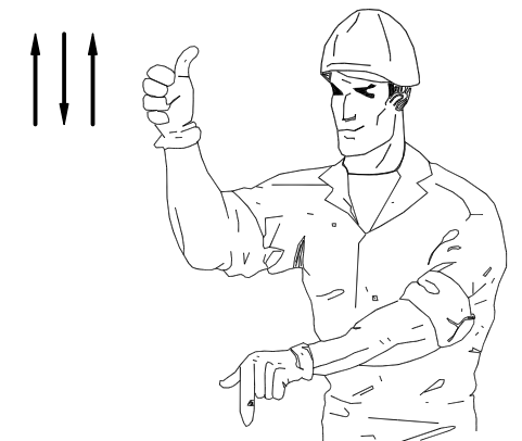
5.- LEVANTAR LA PLUMA O BAJAR LA CARGA
