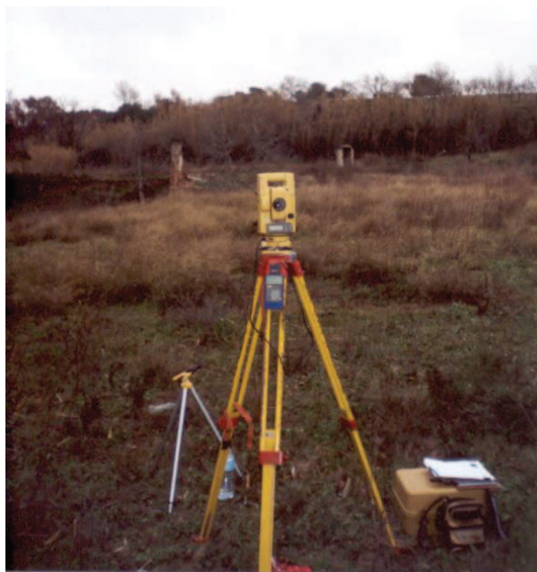
Figura 2.4.3.f: L'estació total permet mesurar angles i distàncies
