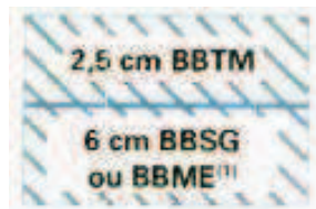
Figura 7: Couche de surface per una structure bitumineuses épaisse GB3/GB3. Catalogue de structures de chaussées [SETRA].
