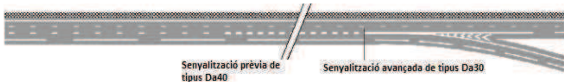
Figura 5: Marques d'un carril de sortida d'autopista amb afectació de carrils [Article 117-3B IISR Partie 7].
