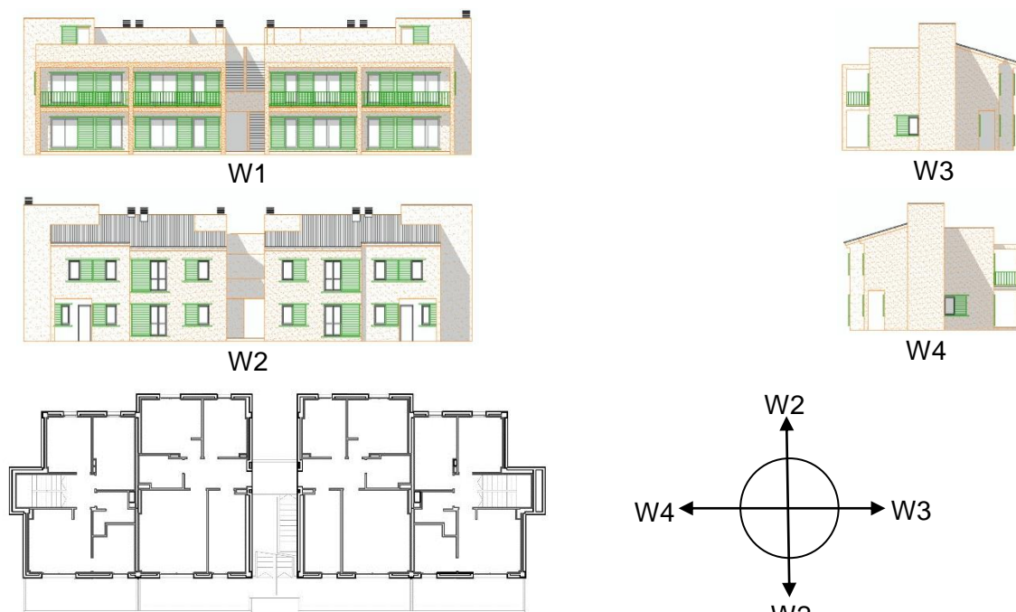
Figura 3.23 – Esquema de aplicación de cargas de viento
