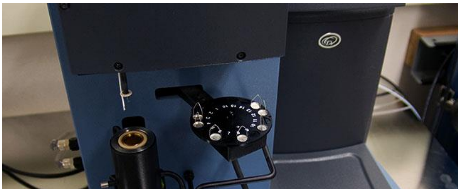
Figura 5.4. Detall de la termobalança del TA Instruments Q50 [18] .
