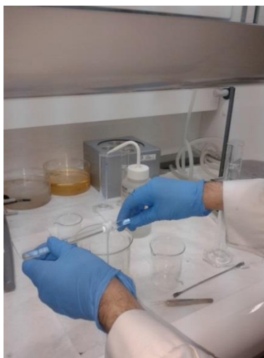
Figura 6.1. Extracció del film de niló 8,9 a mesura que es va formant.
