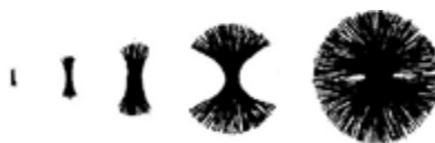
Figura 4.6. D'esquerra a dreta, creixement de l'esferulita fins que assoleix la forma definitiva.
