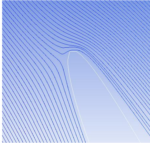
Fig. 33 Línies de corrent al caire d'atac del rotor
