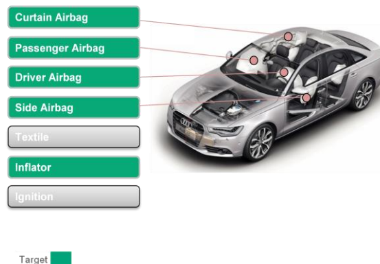
Figura 5: Representació airbag dins el vehicle (Font: Catàleg de Mapro)
