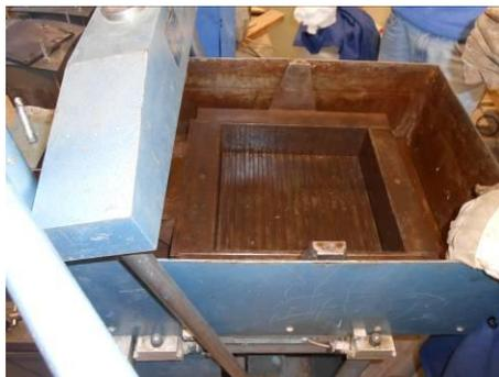
Figura 4.4. Placa porosa inferior colocada.
