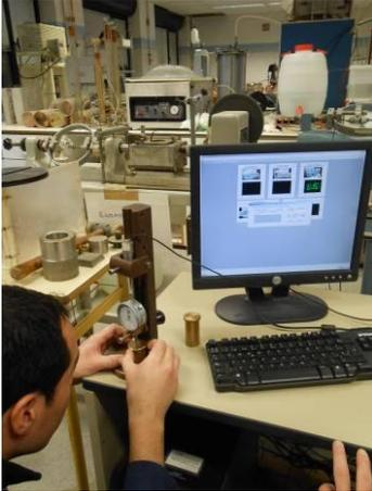
Figura 4.13. Calibración LVDT.
