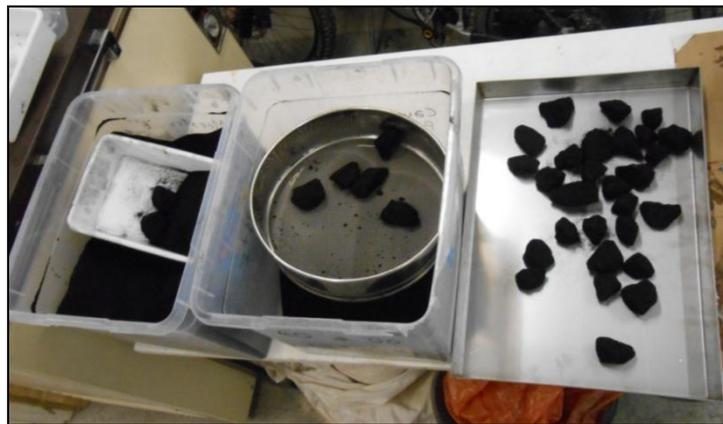
Figura 3.10. Tamizado del árido recubierto
