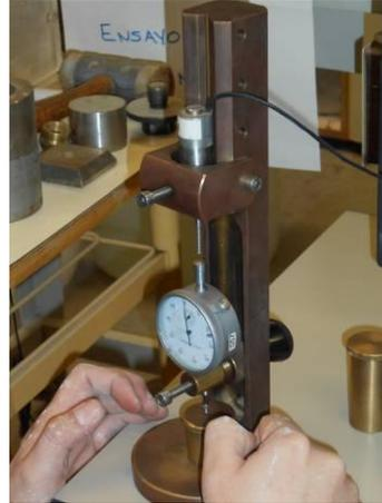
Figura 4.14. Elementos para calibración de LVDT.
