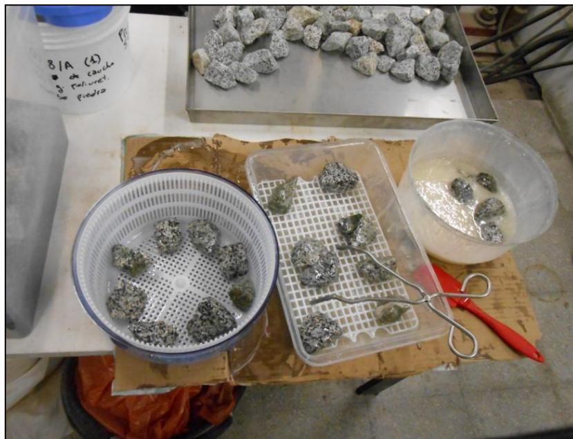
Figura 3.8. Bañado, escurrido y centrifugado de poliuretano sobre árido para balasto.
