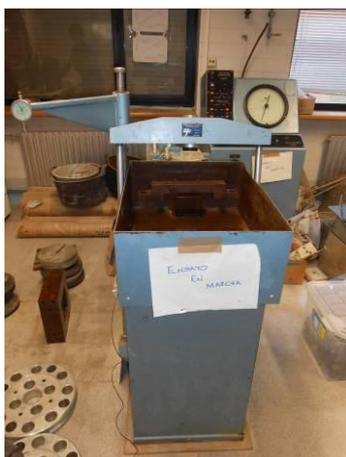
Figura 4.1. Equipo de Corte Directo desmontado, previo al ensayo.
