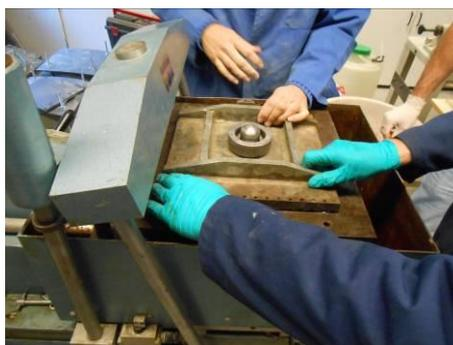
Figura 4.6. Colocación de placa porosa superior (una vez colocada la muestra).
