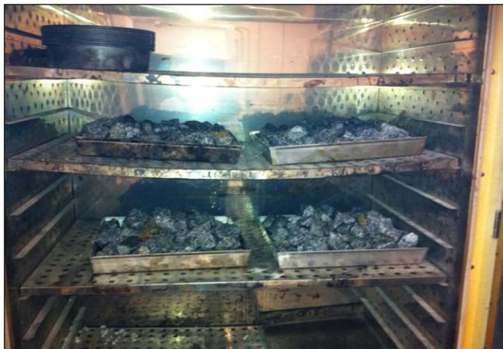
Figura 3.12. Calentamiento del árido a recubrir
