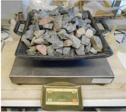
Figura 4.9. Retiro y peso de la muestra total.
