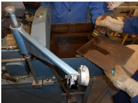
Figura 4.3. Marco inferior colocado y lubricación de placa porosa inferior.
