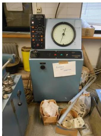
Figura 4.2. Controlador hidráulico del equipo empleado en el ensayo de Corte Directo.
