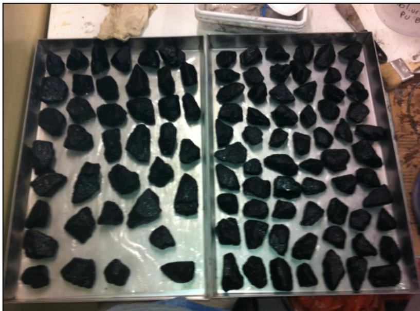
Figura 3.11. Curado del poliuretano correspondiente al segundo baño.
