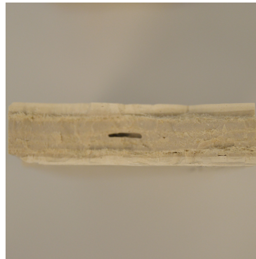
d. Las fibras se muestran degradadas.
