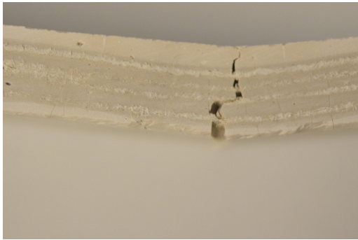
d. Grieta de Rotura, fibras de refuerzo.
