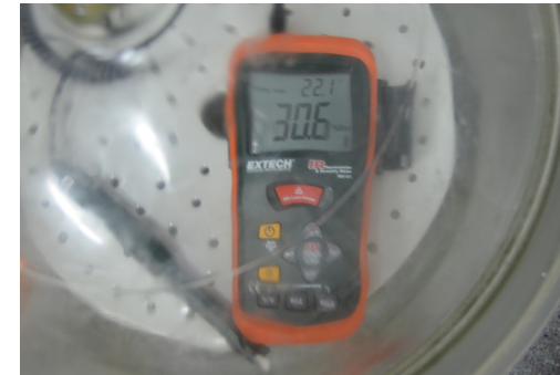
d. Bombona de secado. Se comprueba la humedad relativa en el interior.
