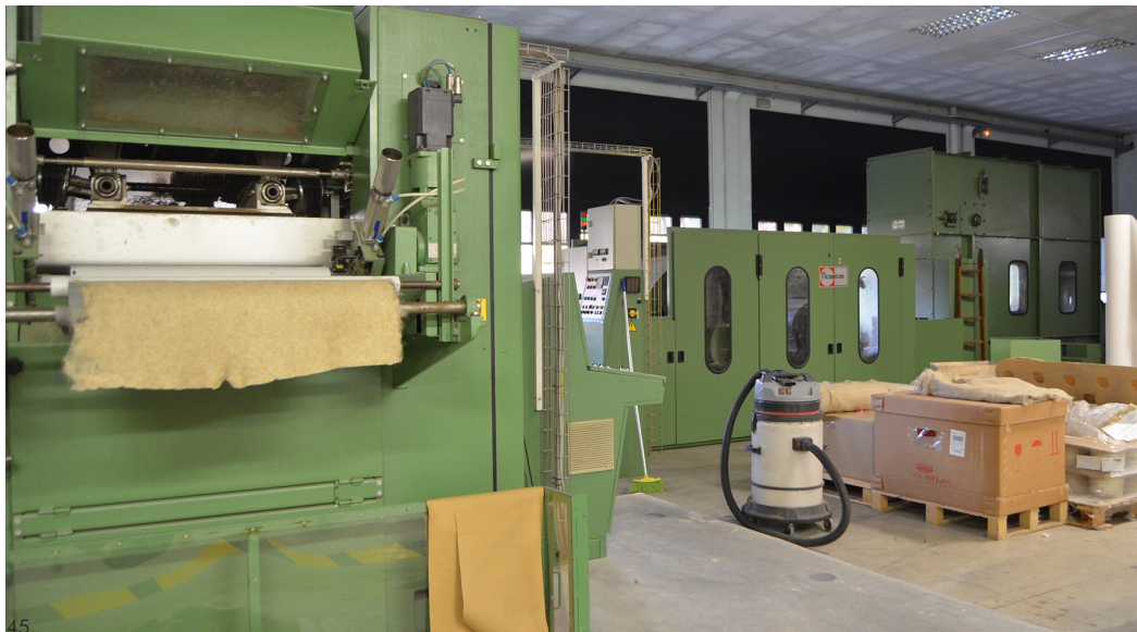
Imagen 45 _ Máquina de fabricación del no-tejido de la ETSEIAT. (Fuente Propia)
