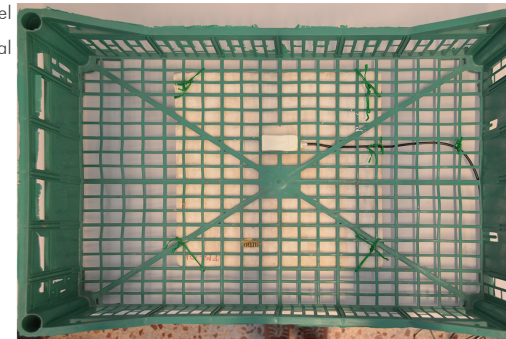
d. Cara posterior del panel blanco, con el sensor de temperatura
