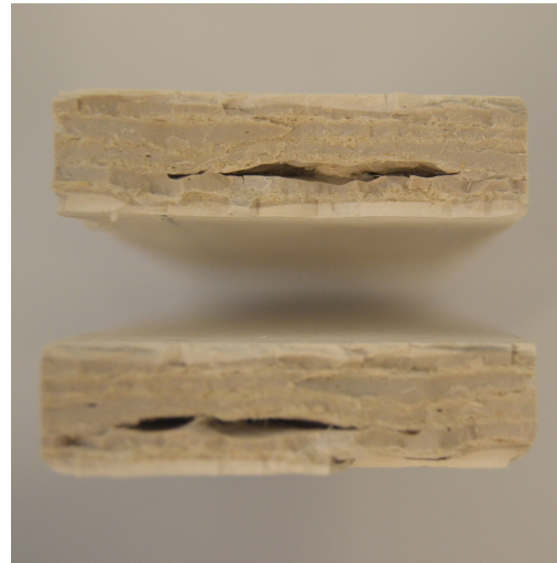
b. Probeta rota a flexión con una burbuja por elaboración
