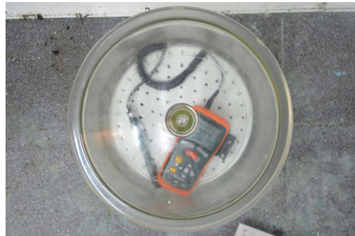
c. Bombona de secado. Se comprueba la humedad relativa en el interior.
