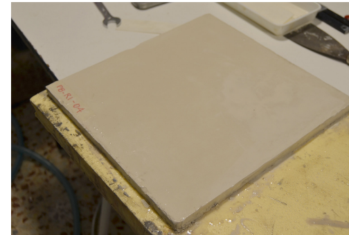
g. Desmoldado del panel
