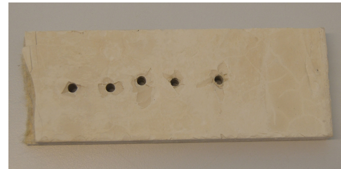
c. Desprendimientos en la parte inferior.
