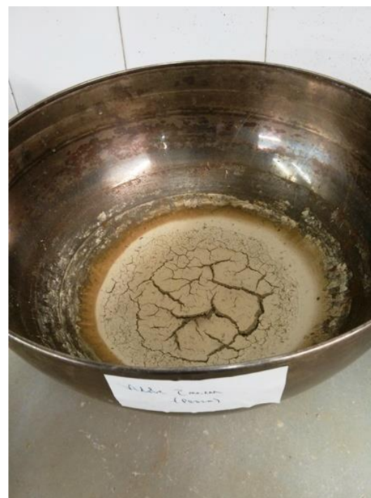
Imatge 7.7.3-1: Argiles (fins de <0,063mm) tretes del forn després de 3 dies. Font: pròpia.
