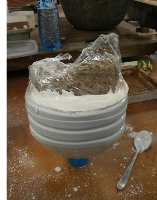
Imatge 7.1.3.2-2: Creant un motlle de guix. Font: pròpia.
