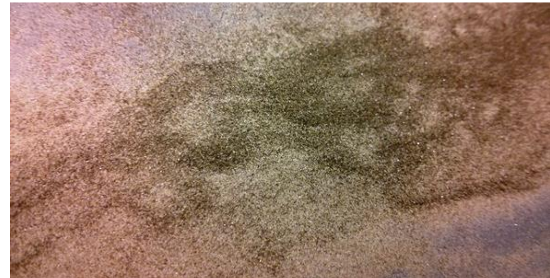
Imatge 7.7.3-2: Les partícules de color clar és tàpia d'entre 0,063 i 0,125mm i les fosques són matèria orgànica. Font: pròpia.
