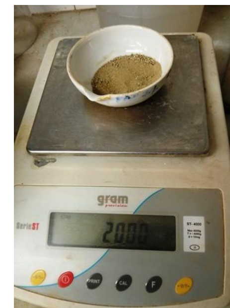
Imatge 7.5.3-1 (esq.): Pesant la tàpia, 20g justos. Font: pròpia.
