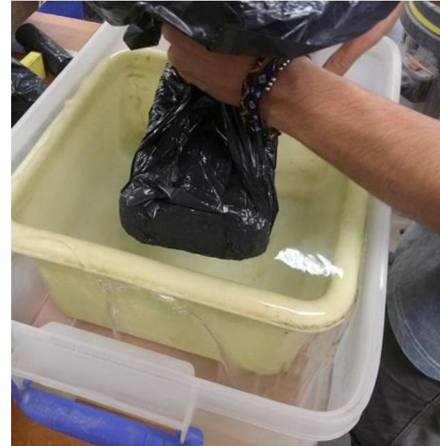
Imatge 7.1.3.2-1: Seguint el principi d'Arquímedes. Font: pròpia.
