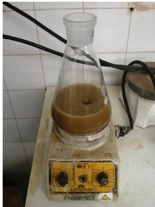
Imatge 7.8.3-1: Fins de tàpia sent agitats. Font: pròpia.
