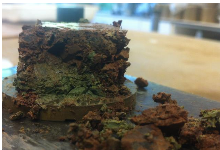
Figura 10: Muestra inalterada del suelo arcilloso del Valle de Pisciolo, correspondiente a la unidad geológica (T) Transicional Flysch y seleccionada para la realización de los distintos ensayos de laboratorio propuestos en la presente investigación. Cabe destacar tanto el aspecto tectonizado y distorsionado de la muestra como la heterogeneidad composicional de límites poco definidos.
