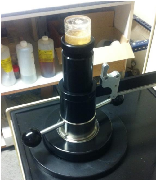
Figura 18: Proceso de eliminación de burbujas de aire en el aceite que aplica la presión en el puerto de alta presión del porosímetro de mercurio Autopore IV 9500. (UPC Campus Nord).
