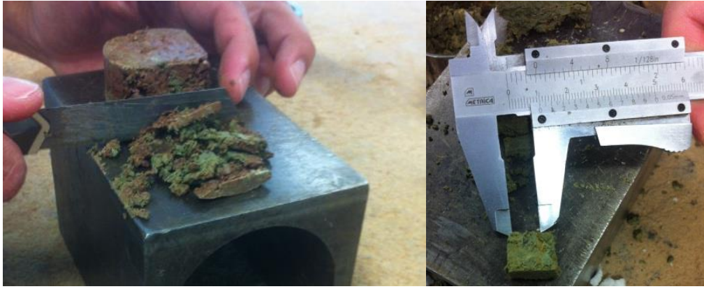
Figura 19: Proceso de obtención de muestras cúbicas para ensayos MIP.
