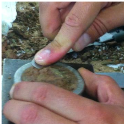
Figura 20: Preparación muy cuidadosa de la pastilla de suelo (PIF1S2) que se somete a saturación bajo carga constante. Se trata de deformar lo menos posible la muestra durante su preparación.
