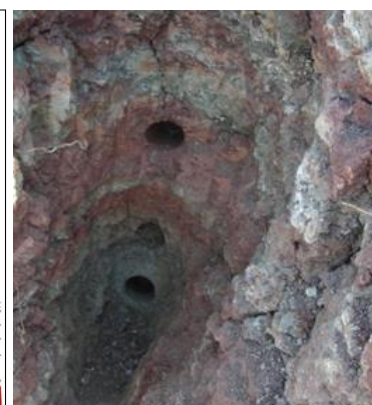
Figura 9: Cata superficial y perforaciones de muestreo de distintas muestras tipo C01 entre 1 y 1.3 m de profundidad. [F. Sollecito, 2012-13]
