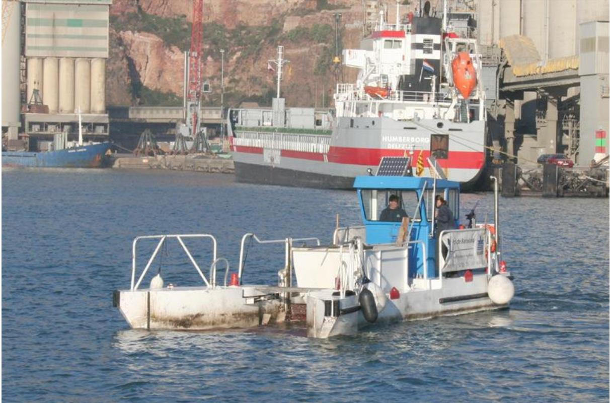
Figura 43: Embarcación recogiendo las partículas flotantes de residuos (Fuente: web del puerto de Barcelona)
