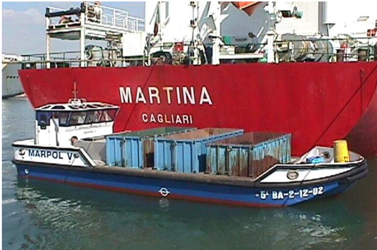
Figura 44: recogiendo los residuos líquidos de un buque (Fuente: Web del puerto de Barcelona)
