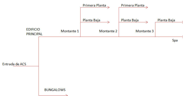
Figura 6.3 Esquema unifilar de la instalación de ACS
