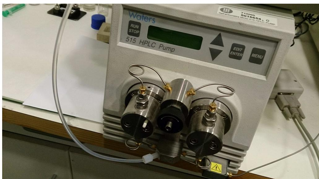
Figura 24 Bomba del HPLC
