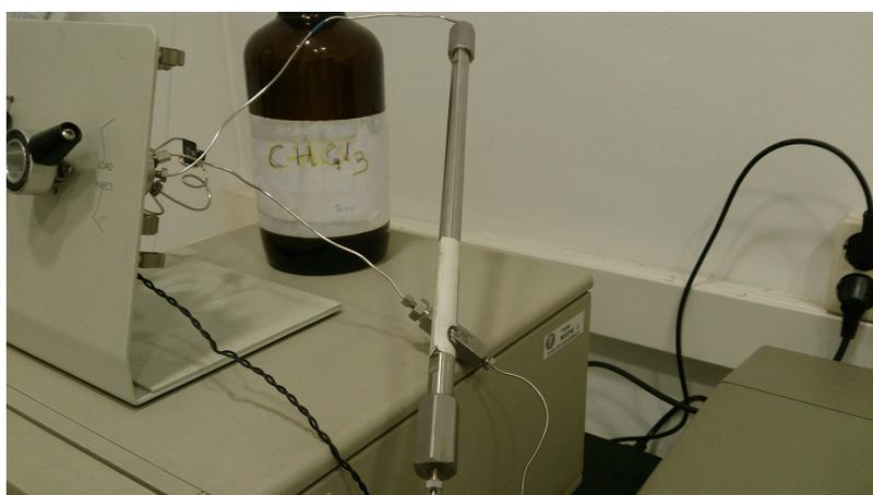
*Figura 26 Columna cromatográfica*
