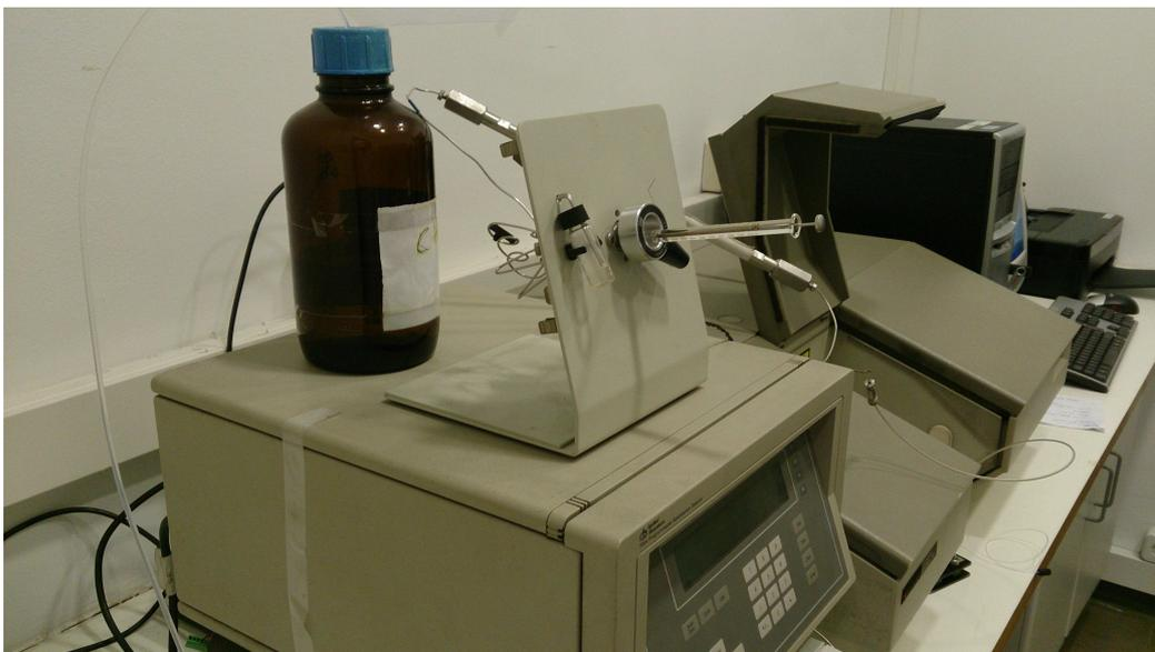
*Figura 22 Inyector con jeringa de inyección*
