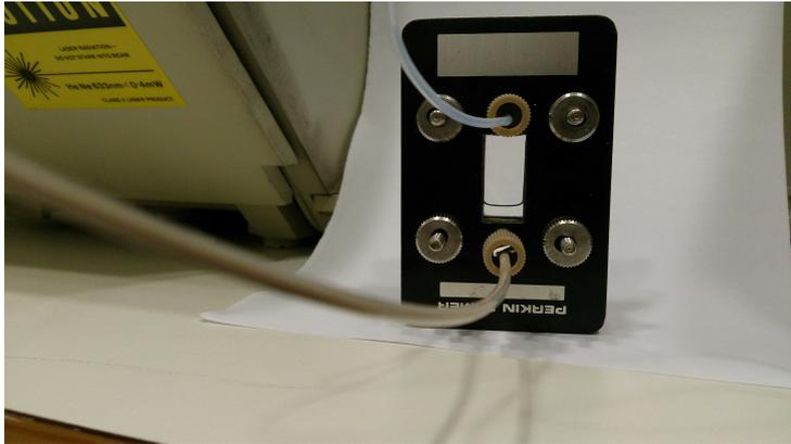
*Figura 34 Inicio del paso de muestra por la ventana*
