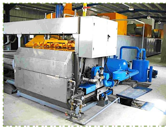
Ilustración 32 Máquina de pulpa de papel moldeada con capacidad para 12 sets Fuente: Made-in-china.com
