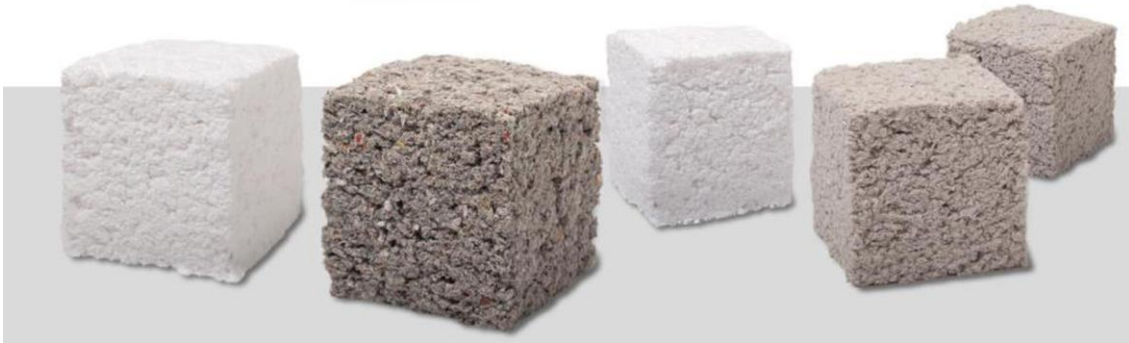
Ilustración 7 Muestra de tipos de celulosa con características diferentes debido al tratamiento industrial que han recibido. Fuente: Celulosa ISOFLOC
