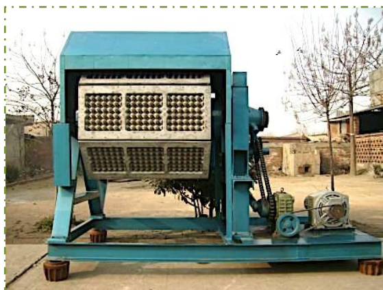
Ilustración 31 Máquina para pulpa de papel moldeada para cartones de huevo Fuente: http://www.apexwallpapers.com/pulp/pulp-molding-machine.html
