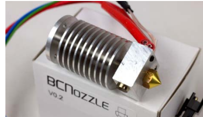
Figura 4. 3. Boquilla de la Fundació CIM . Fuente: 3D print Barcelona [4]
