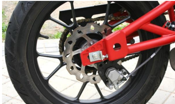
Figura 8. Basculante tubular de triangulación no invertida de acero
