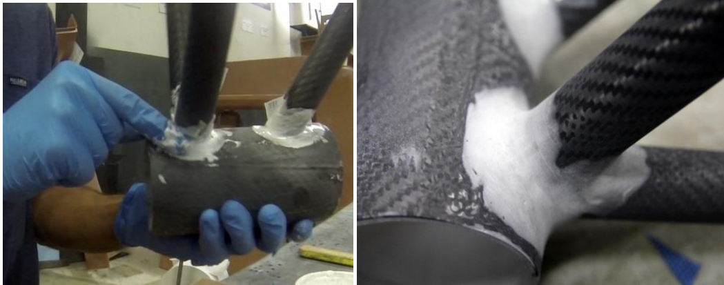
Figura 98. Unión entre tubos mediante la masilla (izquierda) y masilla endurecida (derecha)
