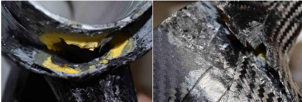
Figura 107. Detalle de la rotura en la unión
