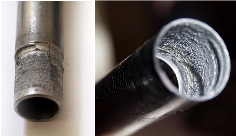
Figura 95. Detalle delaminación del inserto metálico y del tubo de FdeC
