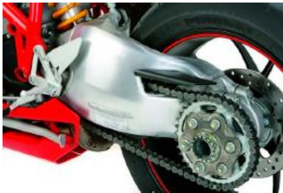
Figura 6. Basculante hueco monobrazo de la Ducati 1098
