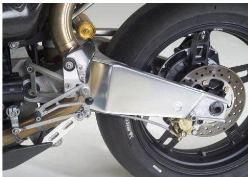
Figura 4. Basculante hueco de triangulación no invertida de aleación de aluminio
