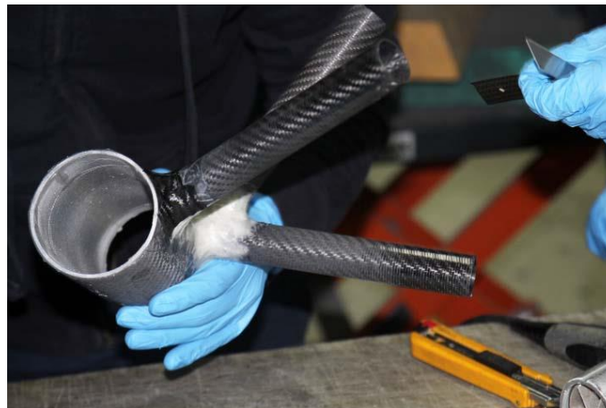
Figura 99. 1ra capa de FdeC encima de la unión enmasillada
