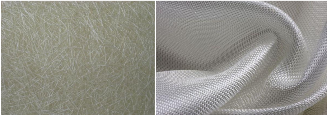
Figura 118. Tipos de fibra: Mat de vidrio (izquierda) y tejido de fibra (derecha)
