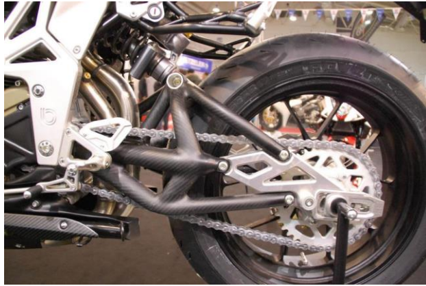
Figura 10. Basculante de Fibra de Carbono tubular de la Bimota DB6 Deliria Superlight
