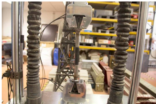
Figura 90. Probeta en la máquina de ensayo a tracción
