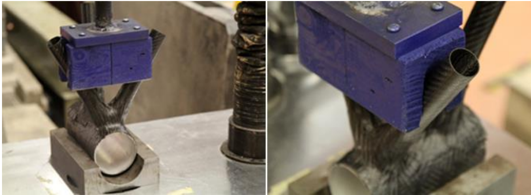
Figura 103. Detalle de la pinza que rodea los tubos
