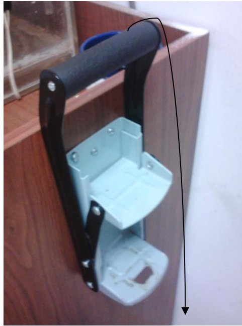
Imatge 9: "Can crusher" moviment
