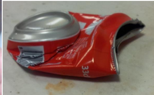
Imatge 7: Llauna xafada verticalment i xafada horitzontalment
