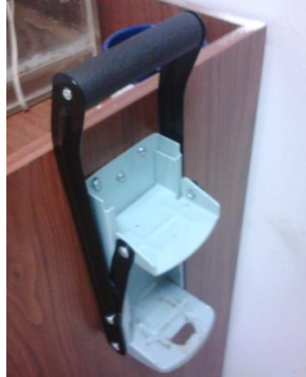
Imatge 2: Premsa "Can crusher"
