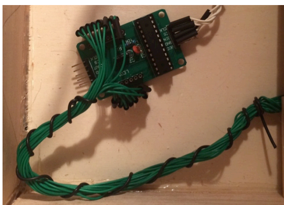
Figura 49 - Conexión de la matriz LED con el integrado MAX7219
