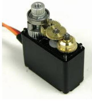
Figura 33 - Interior de un servomotor
