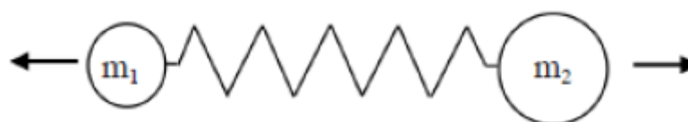
Figura 32 Esquema de oscilador armónico aplicado al análisis de frecuencias de las moléculas [6]
