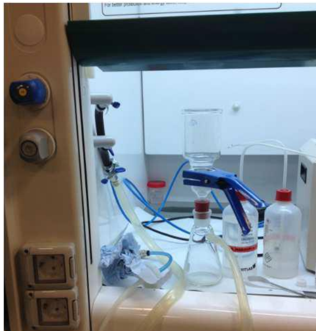
Figura 22 Sistema embudo-kitasato conectado a bomba de vacío
