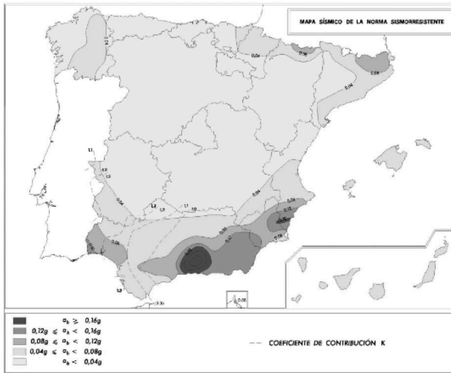
Figura 9. 2. Mapa sísmic de la norma sismoresistent. Font: Norma de Construcció sismoresistent NCSE-024
