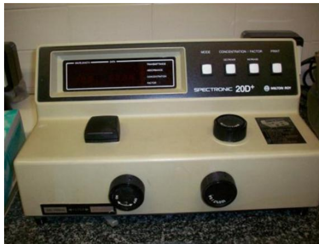
Fig. 4.8 Espectrofotòmetre utilitzat per a mesurar el contingut d'amoni
