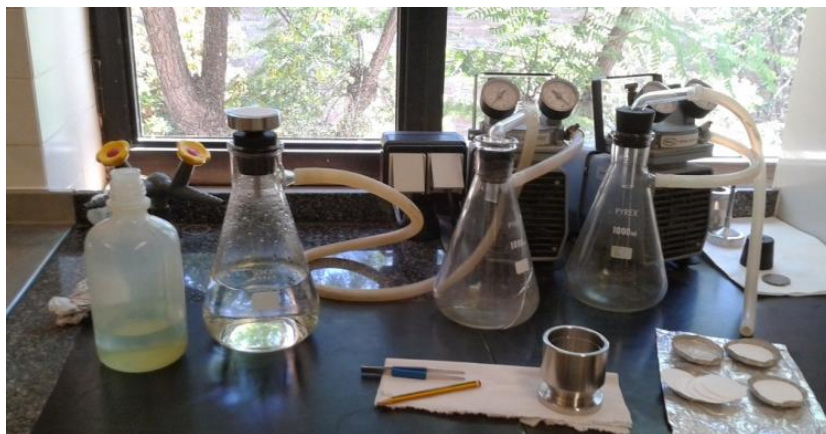
Fig. 4.6 Material per el filtratge de l'aigua residual
