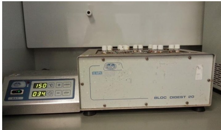
Fig. 4.9 Digestor amb els tubs de rosca col·locats al seu interior
