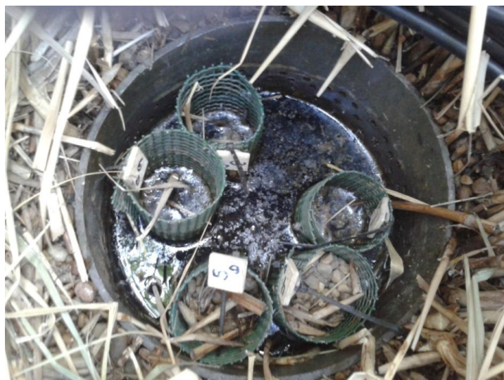
Fig. 4.3 Punt de mostreig de l'aiguamoll amb els testimonis de grava a l'interior de la canonada
