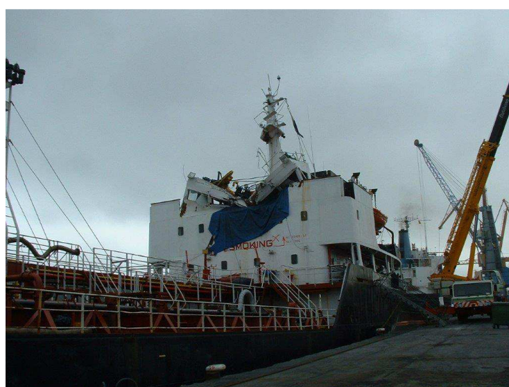
Figura 36: Daños producidos al buque tanque por colisión de la pluma de la grúa.
