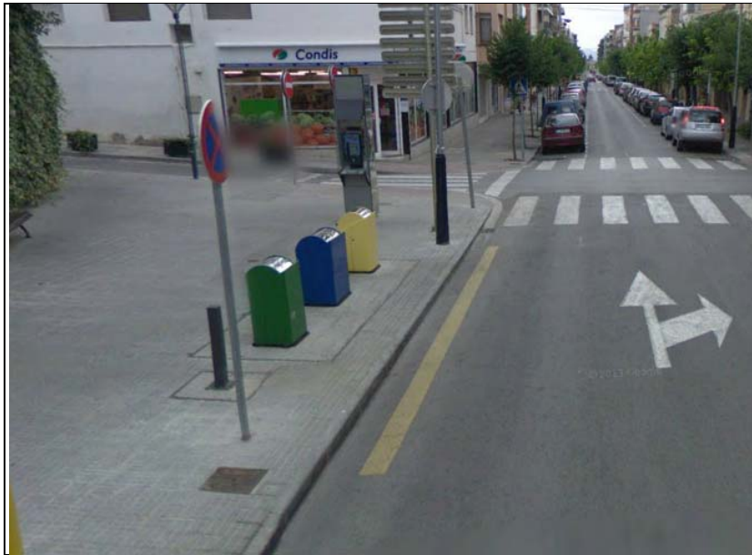
Sistema de recollida selectiva soterrat al carrer dels Banys de la Garriga.
