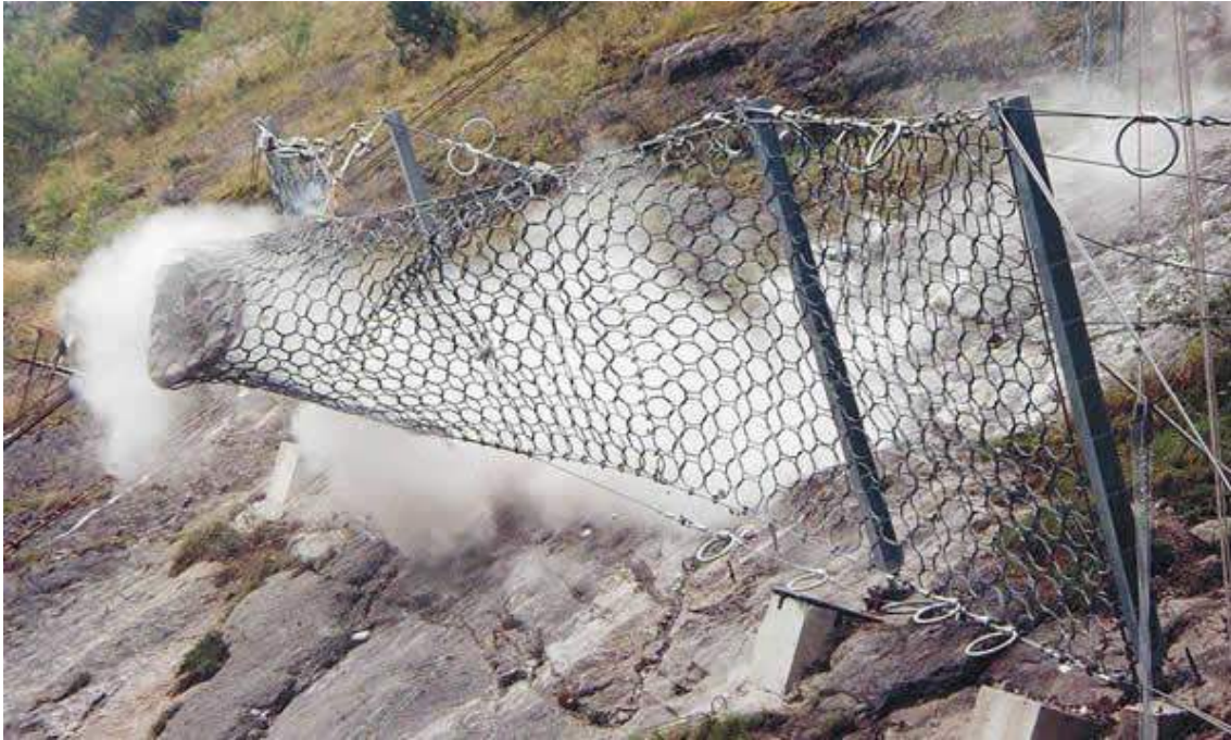
Figura 2.1. Funcionament de les pantalles dinàmiques
