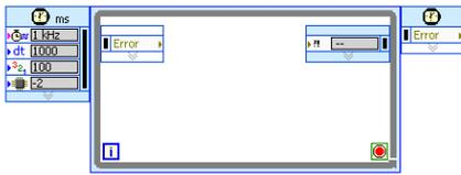
**TIMED LOOP:** el dibujo recuerda a un while loop, pero no es necesaria ninguna condición para su funcionamiento, una de sus características es la posibilidad de programar con que frecuencia se repetirá el código de su interior.
