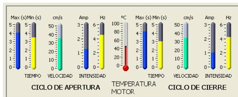
Fig. 5. 12. indicador de prestaciones, de izquierda a derecha, tiempo máximo de apertura (azul), tiempo mínimo de apertura (amarillo), velocidad del último ciclo de apertura (turquesa), Amplitud en la apertura (azul), frecuencia en la apertura (amarillo), indicador de temperatura (rojo), tiempo máximo de cierre (azul), tiempo mínimo de cierre (amarillo), velocidad del último ciclo de cierre (turquesa), Amplitud en el cierre (azul), frecuencia en el cierre (amarillo).
