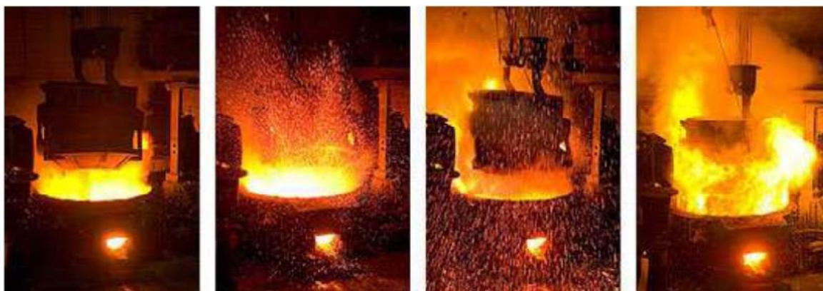
*Fig. 4.5 Proceso de carga de chatarra mediante cesta a través de la bóveda del EAF*
