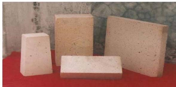
*Fig. 3.16 Ladrillos refractarios con base de silicio y alúmina*
