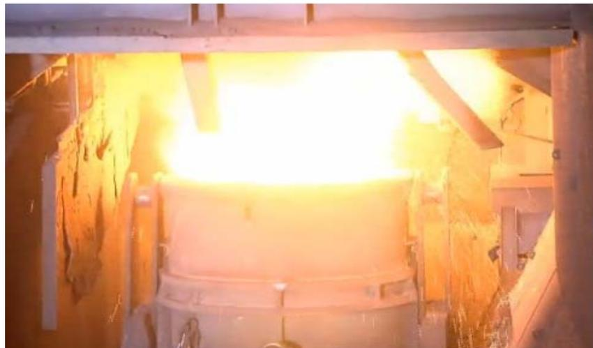
*Fig. 4.6 Vuelco de una colada a la cuchara a través del EBT*
