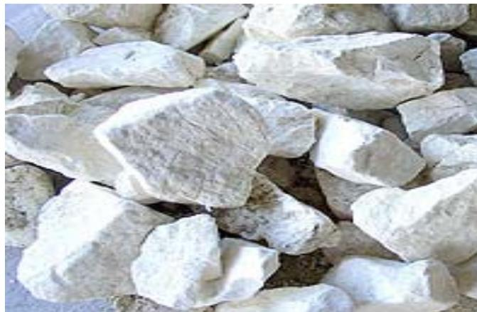
*Fig. 3.14 Muestras de cal antes de ser introducidas en el acero*
