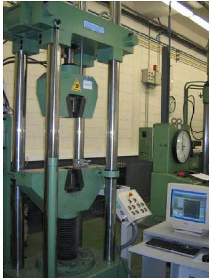
*Fig. 5.4 Máquina de ensayos de 100tn*
