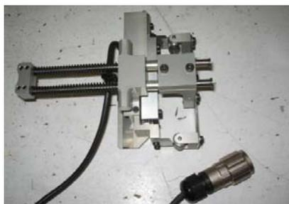
*Fig. 5.5 Extensómetro digital SERVOSIS*
