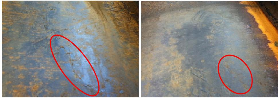
*Fig. 6.5 Alma del perfil HEB400 con defectos superficiales*
