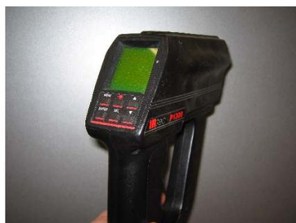
*Fig. 5.8 Pirómetro portátil*
