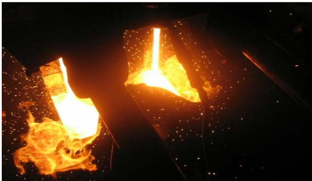
*Fig. 4.10 Chorros de acero cayendo sobre lingotera de Beam Blank (formato BB3.1)*
