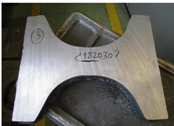
Fig. 6.18 Sección transversal del BB con 20% de poros
