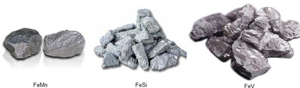
Fig. 3.15 Muestras de de algunos tipos de ferroaleaciones con diferente granulometría añadidos en la fabricación del acero, como son el FeMn, el FeSi y el FeV
