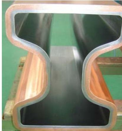
*Fig. 4.9 Lingotera de Beam Blank*
