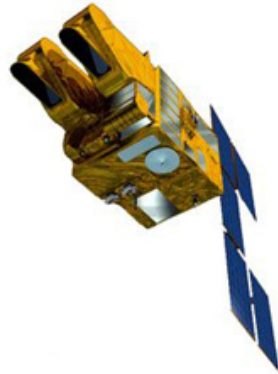
Figura 6. SPOT-5 amb sensor VEGETATION incorporat
