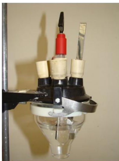
Fig. 8.1. Fotografía de la celda electroquímica utilizada, con los tres electrodos posicionados, pero sin conectar a la fuente externa de energía eléctrica.
