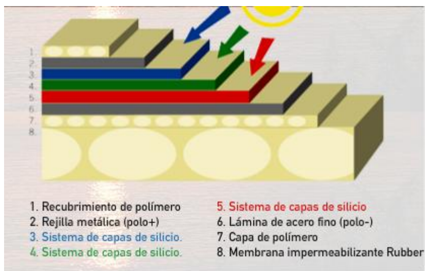
Figura 6.1. Composición de una lona fotovoltaica
