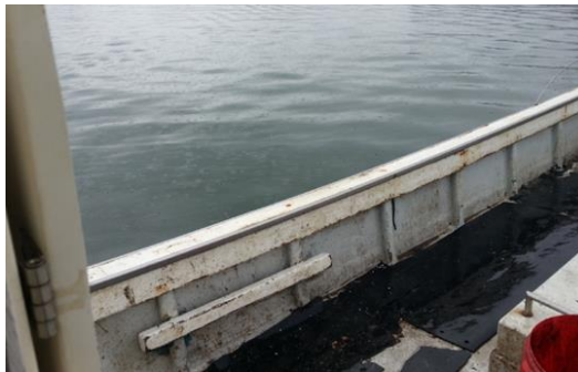
IMATGE(31) - Orla del vaixell sense baranes de seguretat
