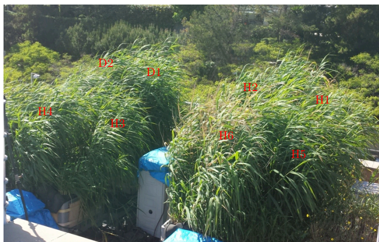
Figura 4.4. Tractament secundari: planta pilot dels vuit aiguamolls construïts
