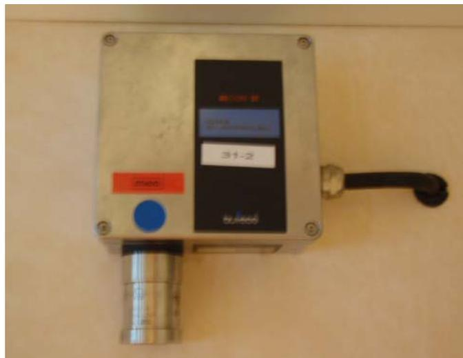
Figura 71: Detector de gas en la acomodación
