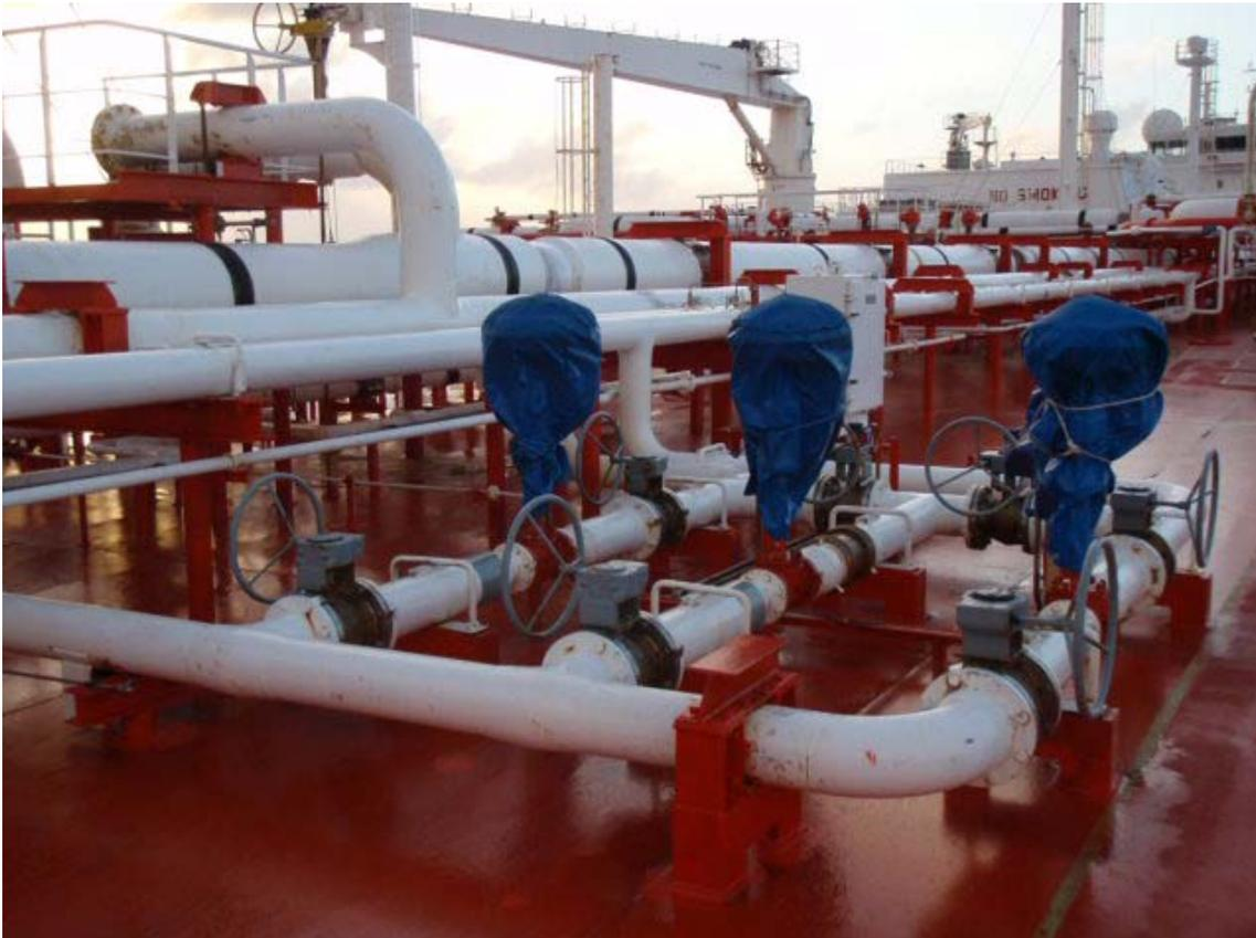
*Figura 92: Válvulas de regulación de presión de nitrógeno*
