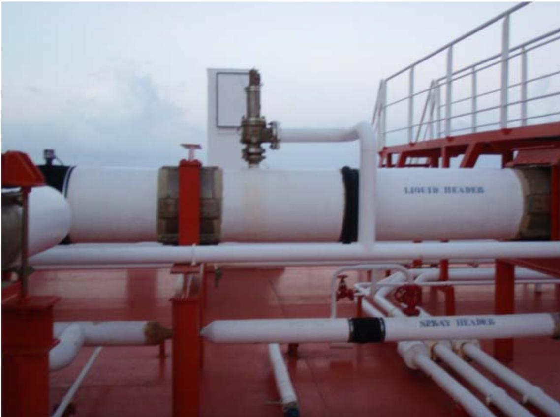
*Figura 45: Válvula de seguridad de la línea de líquido*
