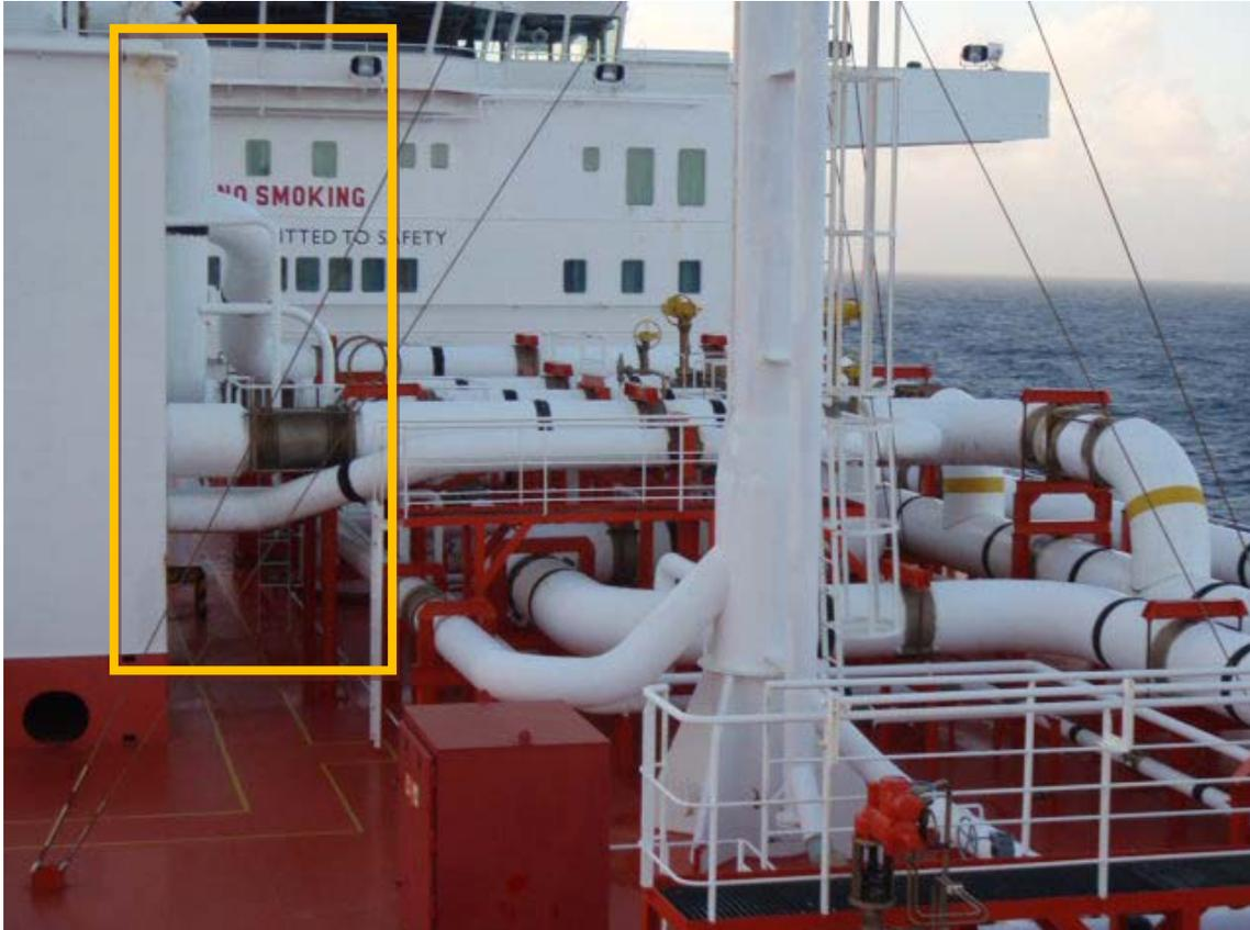
*Figura 44: Conexión de las líneas al cuarto de compresores*
