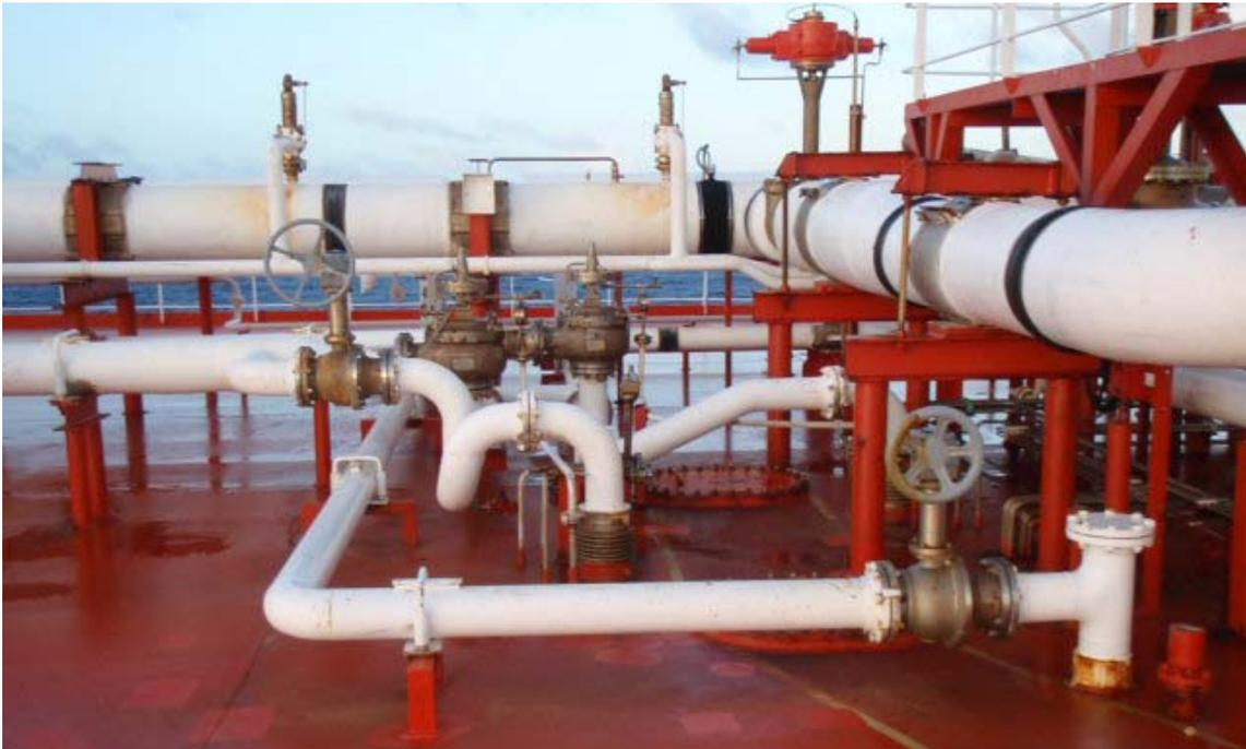
*Figura 78: Válvula de alivio de la barrera primaria*
