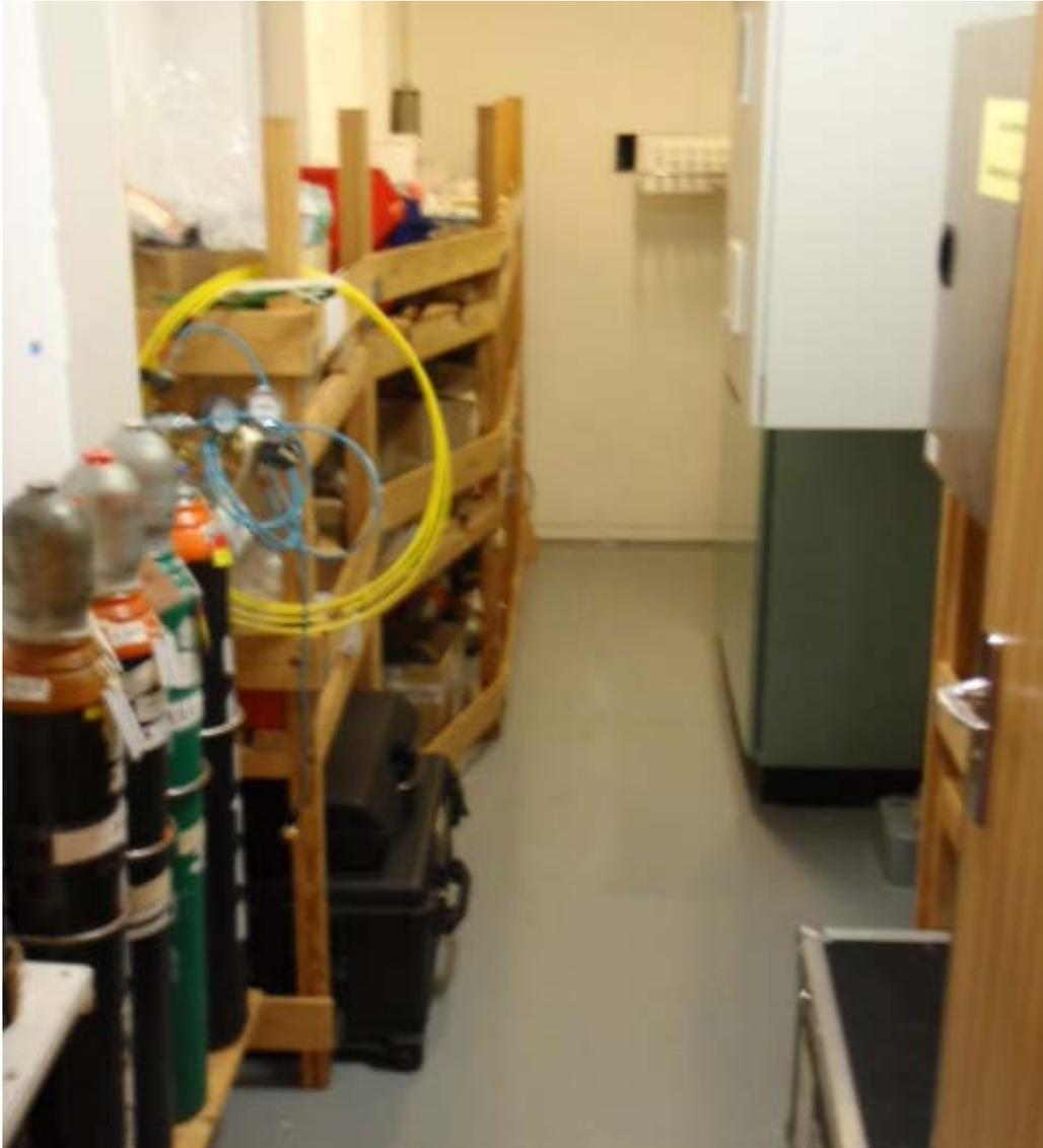
*Figura 68: Cuarto del ingeniero de carga con las botellas de calibración y los analizadores infrarrojos de los puntos de muestreo exteriores*
