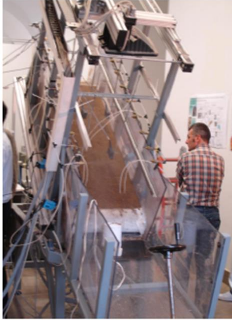
Figura 33. Fotografía del equipo utilizado para hacer el ensayo de infiltración.
