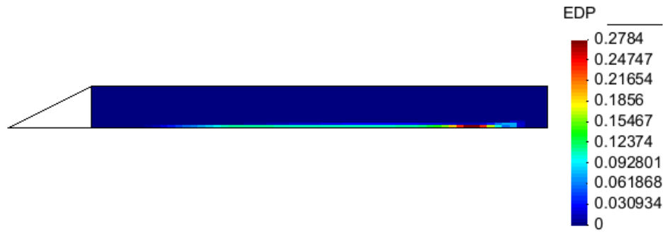
Figura 65. Ensayo C4. Deformaciones de corte plásticas al finalizar el ensayo de infiltración.
