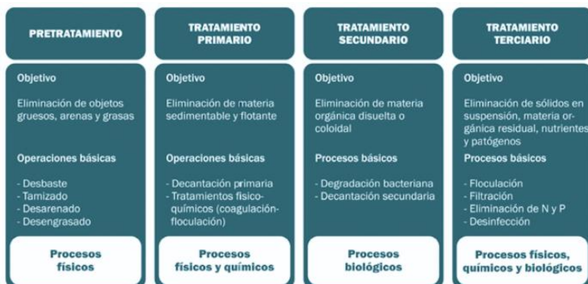
Figura 4: Etapas del tratamiento de las aguas residuales urbanas, ordenadas secuencialmente de izquierda a derecha (Secretariado Alianza por el Agua/Ecología y Desarrollo, 2008).
