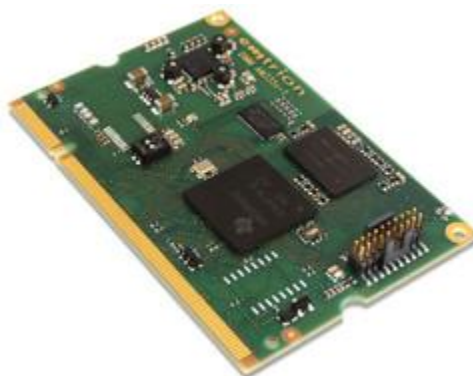
Fig. 7.2. Mòdul del Processador SODIMM Module DIMM-AM335x
