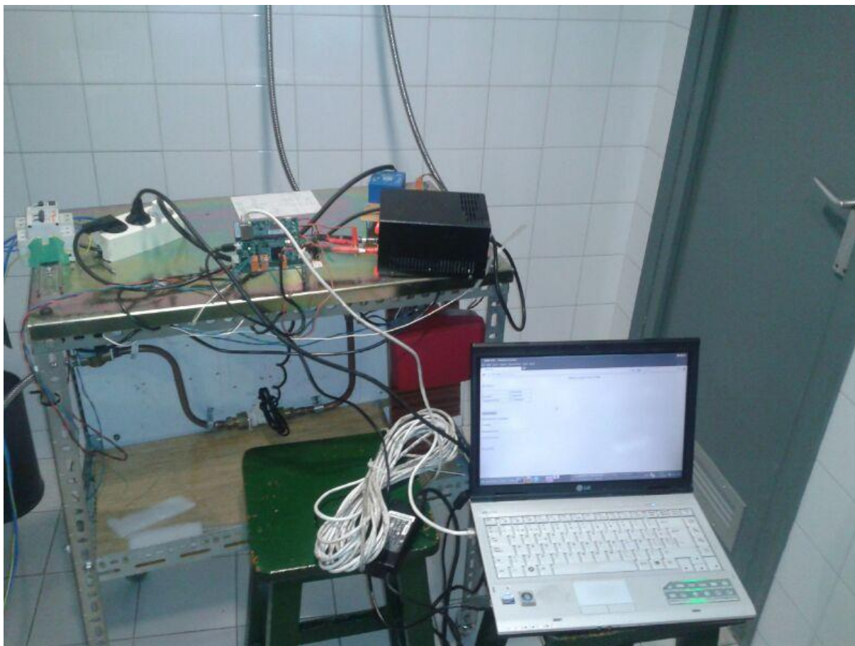
Fig. 9.7. Sistema de fontaneria amb interfície home-màquina
