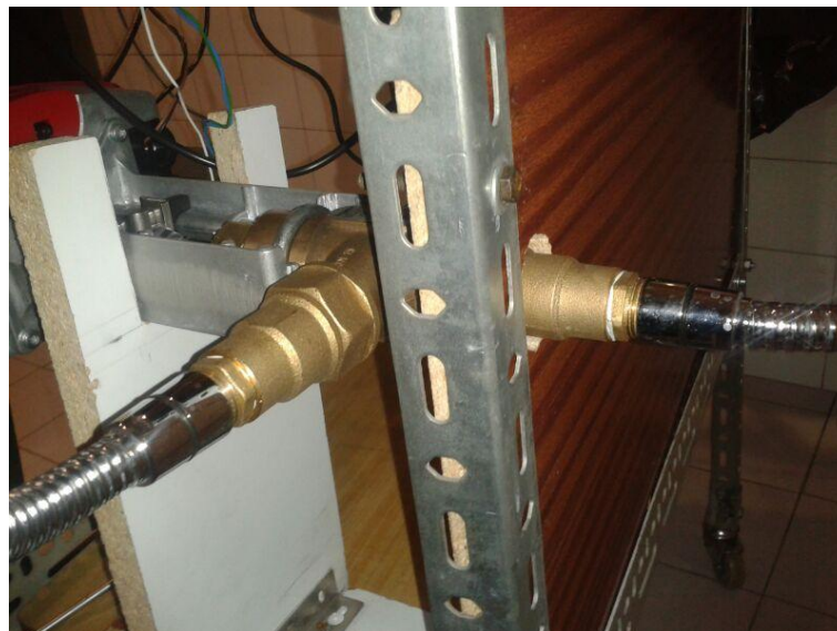
Fig. 9.1. Detall de la vàlvula mescladora i entrades freda i calenta
