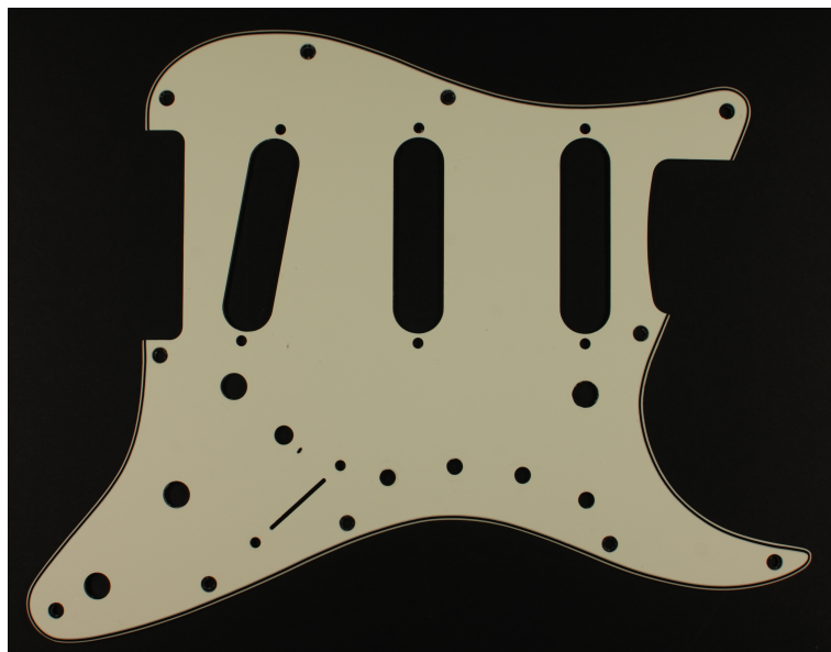
Figura 89. Colpejador de la guitarra després de la mecanització.
